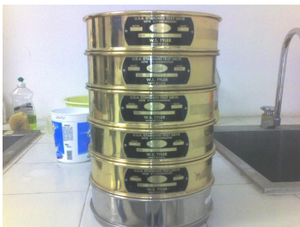
Figura 16 Juego de tamices utilizados para el análisis de tamaño de partícula.
