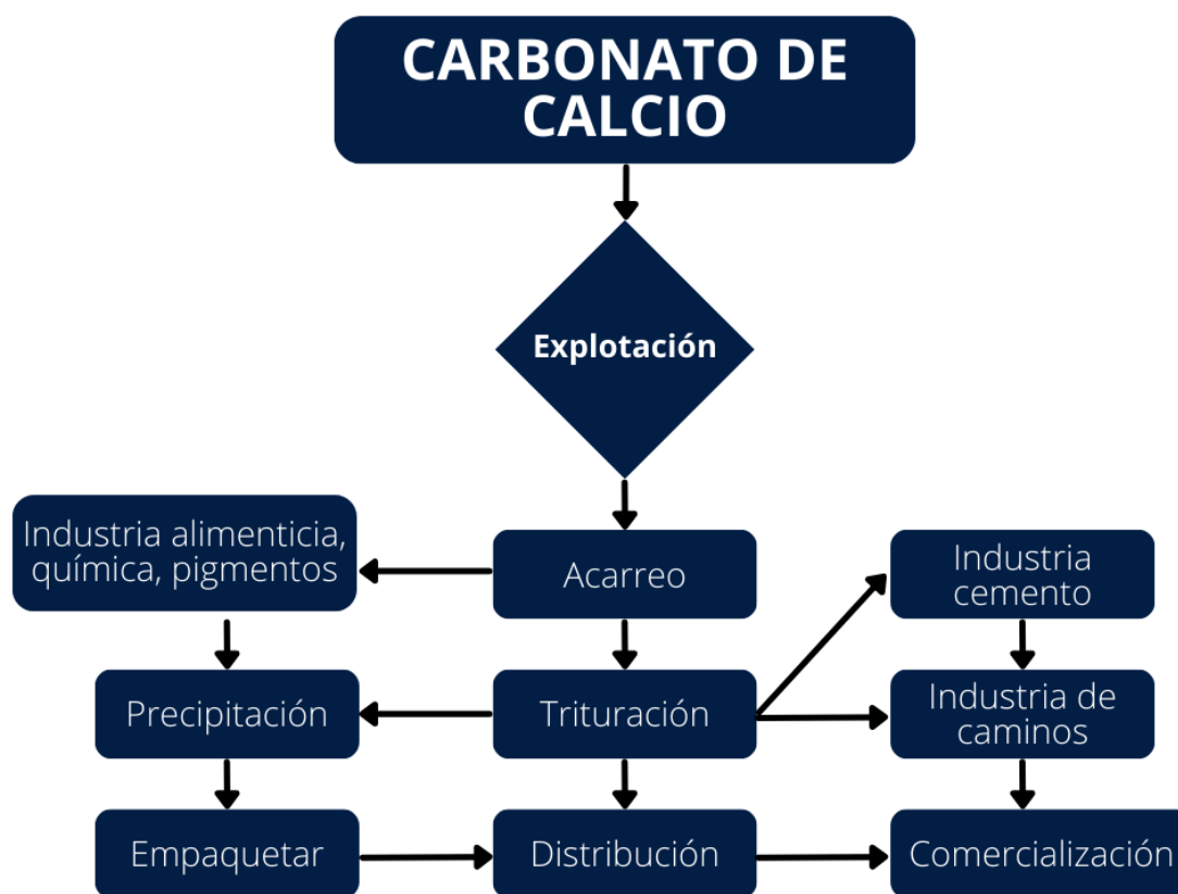
Figura 9 Cadena de producción del carbonato de calcio.
