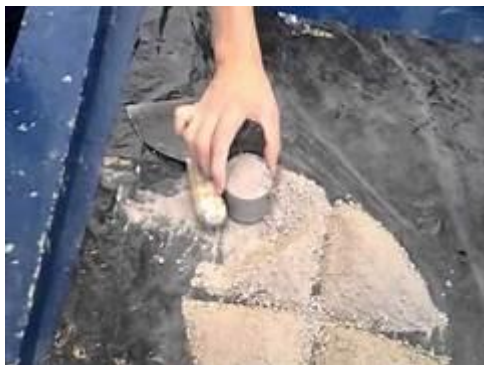
Figura 17 Cono sobre la placa; para obtener el peso de la arena retenida
