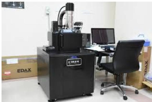
Figura 15 Microscopio Electrónico de Barrido (MEB)
