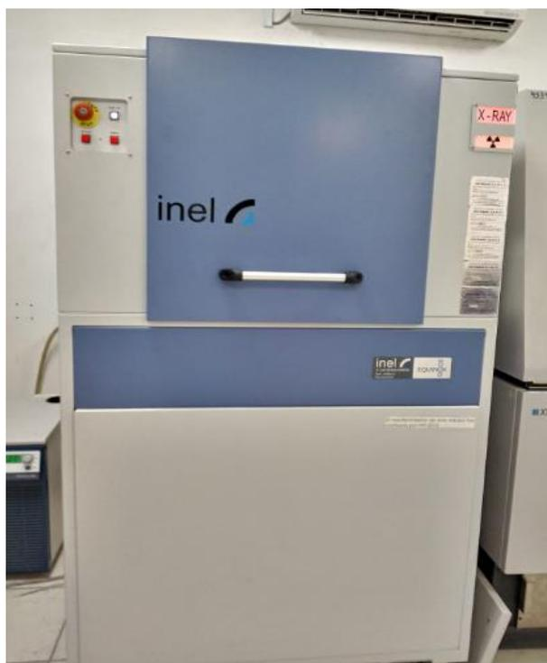
**Figura 4.** Difractómetro de Rayos X
