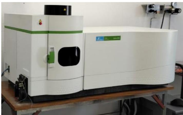
**Figura 2.** Espectrómetro de Emisión de Plasma Acoplada por Inducción.
