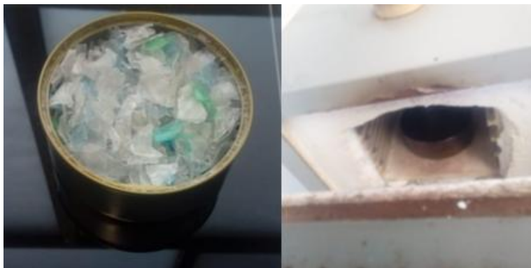
Figura 33. A la izquierda se muestra el recipiente con PET reciclado, a la derecha se muestra el recipiente y el PET reciclado dentro del horno
