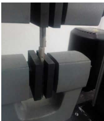
Figura 38. Fractura de probeta de PET reciclado sujeto a tracción
