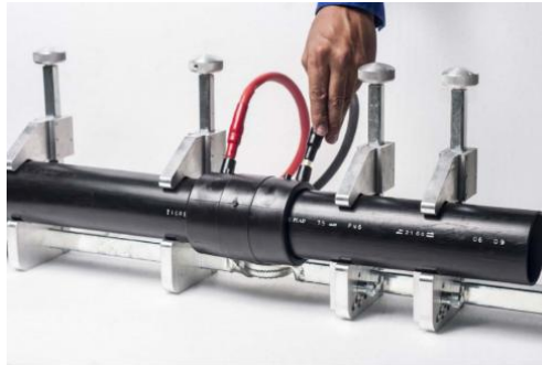
Figura 2. Unión de tubo PEAD por temperatura con electrofusión, (TIGRE S.A., 2016)
