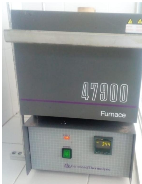
Figura 32. Horno Barnstead para fundición de PET reciclado
