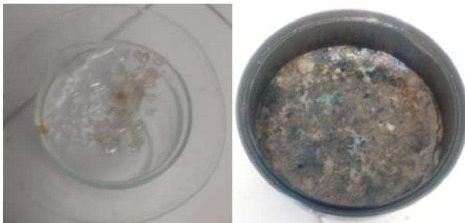
Figura 31. En la ilustración izquierda se muestra PET virgen fundido totalmente transparente y PET reciclado transparente fundido que ahora presenta pigmentos de color café. En la ilustración derecha se aprecia el color que adquiere el PET reciclado fundido con diferentes pigmentos.
