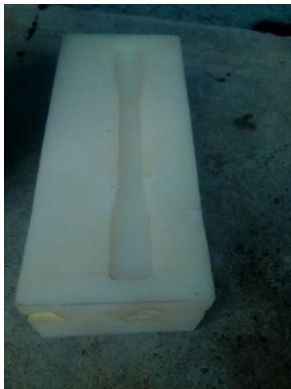
Figura 28. Molde Naylacero para colar probetas de tracción de PET reciclado
