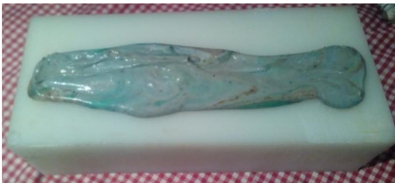
Figura 34. PET colado en un molde para probetas de tracción
