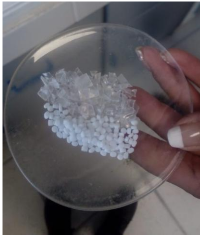
Figura 30. PET virgen en forma granular y PET reciclado transparente en forma de laminillas antes de su fundición
