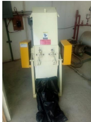
Figura 21. Molino para plástico RECITAB 20hp, para trituración del PET
