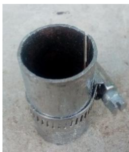
Figura 27. Molde de sujeción con abrazadera, para recortar imperfecciones de cilindros de PET reciclado
