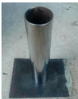
Figura 26. Molde acero galvanizado con diámetro interior de 1”, utilizado para colar PET reciclado
