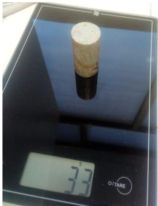
Figura 44. Determinación del peso de las probetas de compresión en una báscula WMF profile select®
