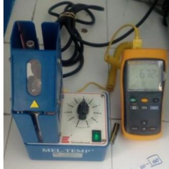
Figura 24. Determinación punto de fusión del PET
