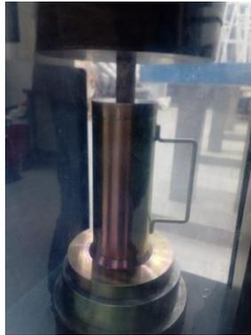
4.9 Figura 39. Cilindro de PET reciclado colado sujeto a compresión en una máquina de ensayos CONTROLS PILOT® con extensión
