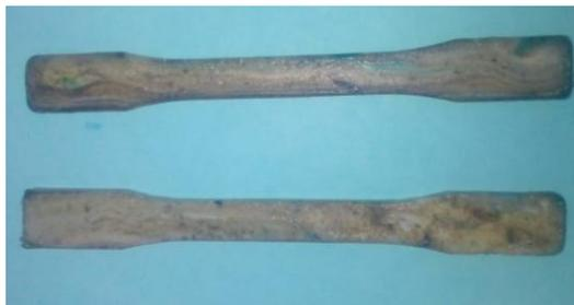
Figura 36. Probetas de tracción de PET reciclado
