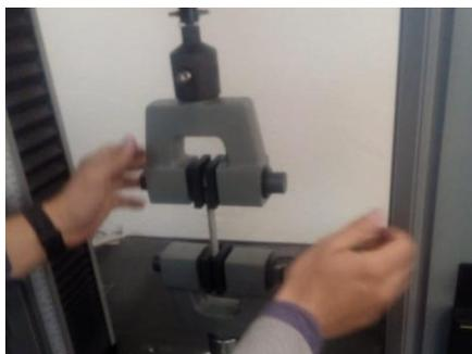
*Figura 37. Colocación de probeta de PET reciclado colado, en una máquina de pruebas a tracción INSTRON 4465*
