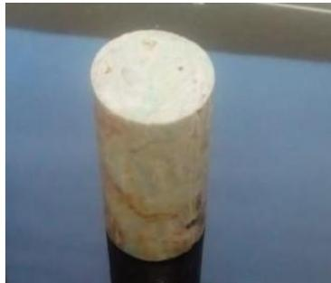
Figura 35. Probeta cilíndrica de PET reciclado
