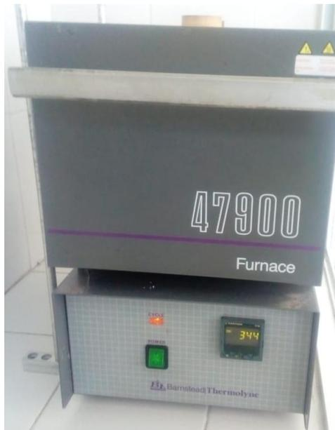
Figura 32. Horno Barnstead para fundición de PET reciclado
