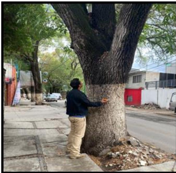
Figura 22 .Medición de diámetro Normal con cinta diamétrica (J-Campos).
