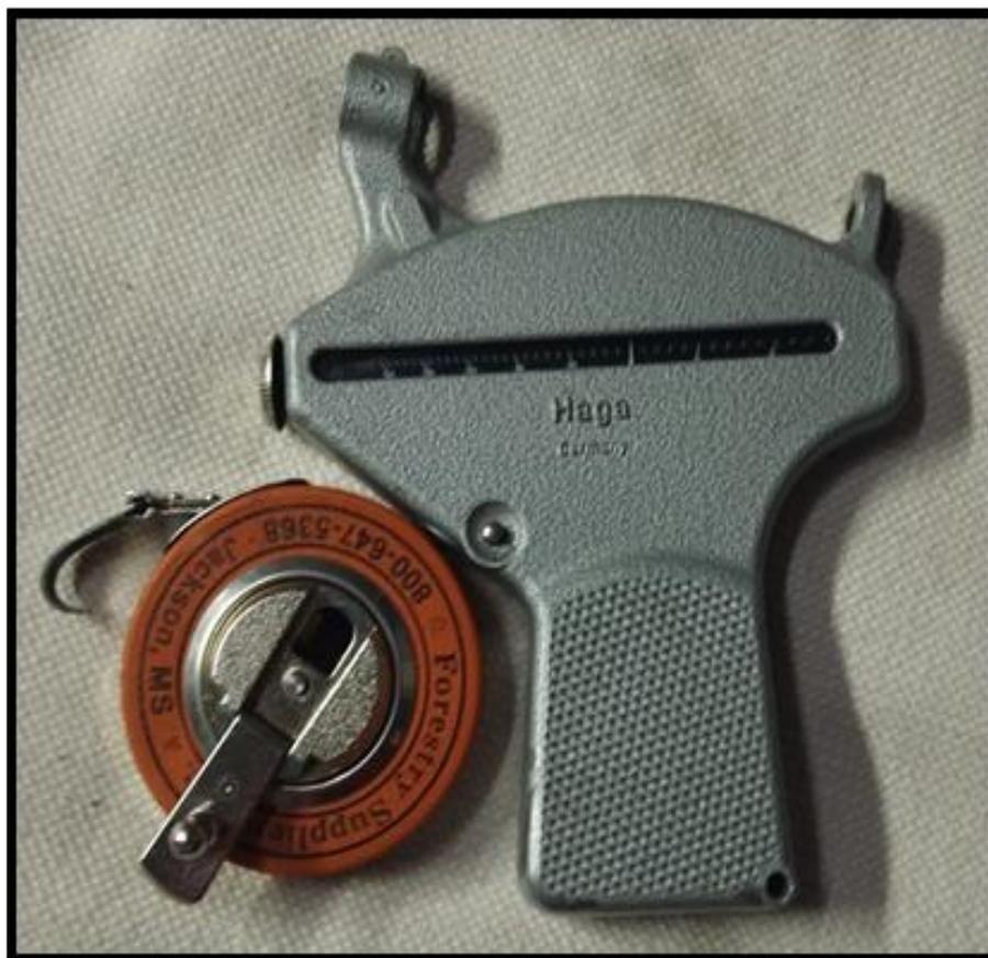
Figura 21. Instrumentos de Medición "Pistola Haga y Cinta diamétrica" (J-Campos).
