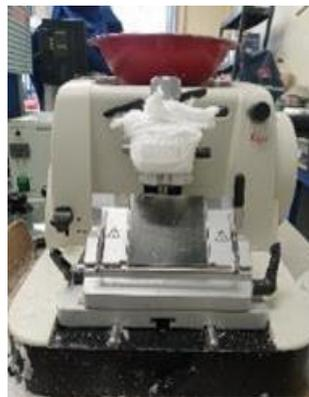
**Figura 9.** Micrótomos Marca Leica.
