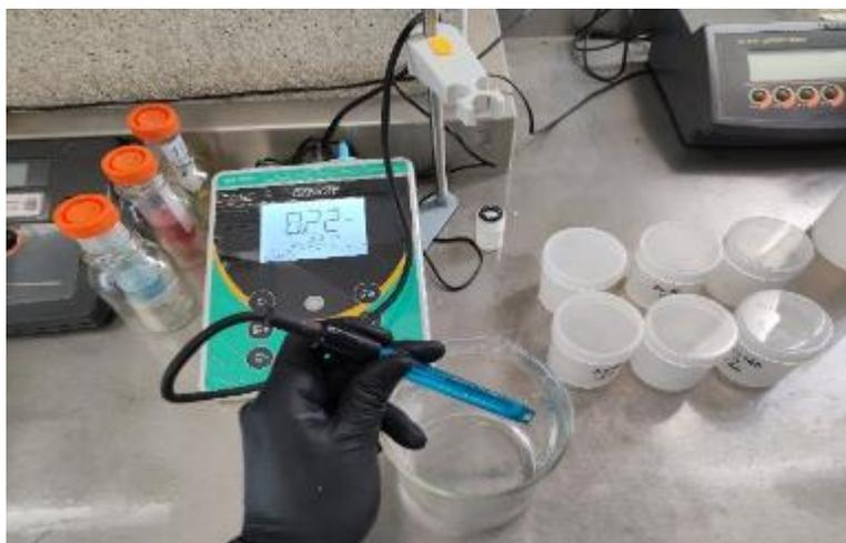
**Figura 15.** Monitoreo de pH para los extractos de los tratamientos, se realizó utilizando un potenciómetro Oakton 550 con sonda.
