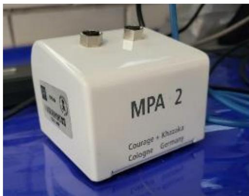
**Figura 26.** Sistema adaptador multisonda (C+K Electronic MPA 2, TM 300, Courage + Khazaka electronic GmbH, Köln, Alemania).
