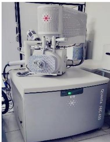
**Figura 19.** Equipo empleado para hacer microscopía QUANTA FEG 450.
