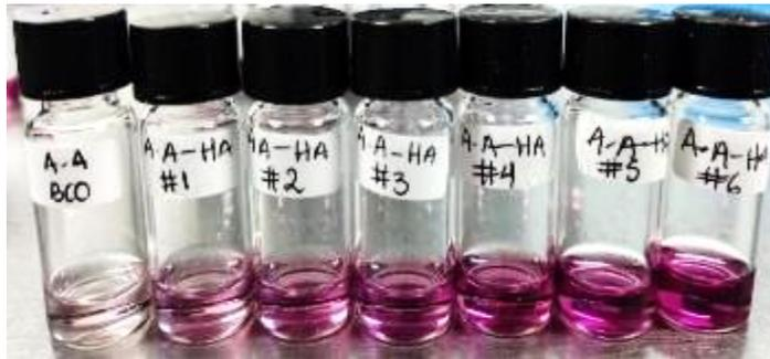
**Figura 34.** Reacción de carbazol de la solución madre con ácido hialurónico con ácido acético 0.5 M (AA).
