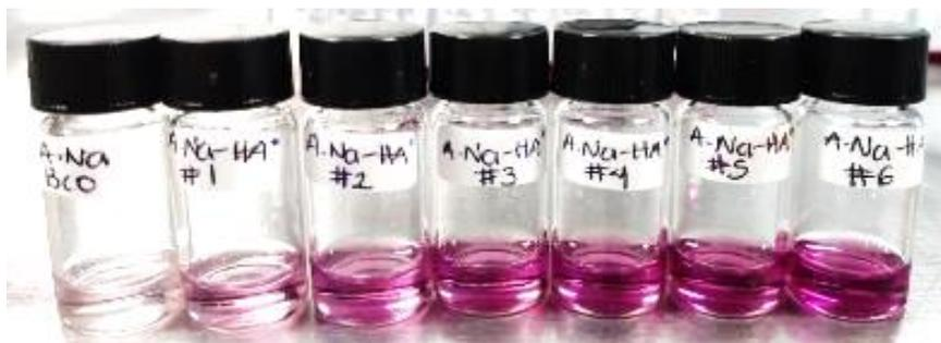
**Figura 36.** Curva de calibración de solución de ácido hialurónico con acetato de sodio 5% (A).
