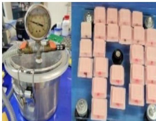
**Figura 23.** Elaboración de sistemas transdérmicos: a) Equipo de vacío y b) Secado de los arreglos de microagujas en condiciones ambientales.
