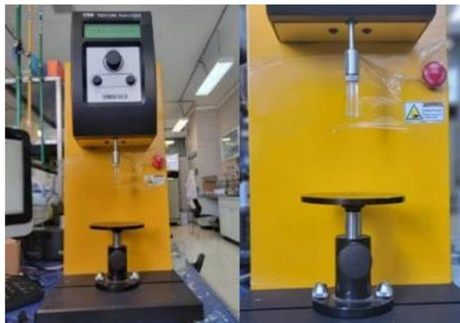
**Figura 24.** Equipo (Brookfield modelo CT3 Texture analyzer, USA con TexturePro CT Software) para pruebas mecánicas.
