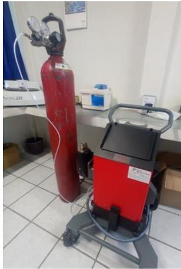
**Figura 29.** Espectrómetro de emisión óptica para determinar composición química. Fuente: Propia.
