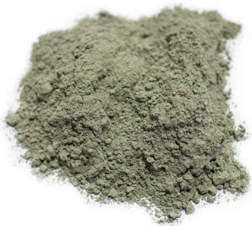
Figura 2.5.2. Polvo de roca basáltica generado como subproducto industrial.
