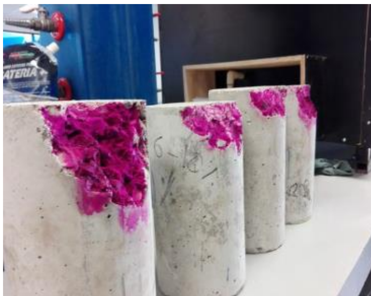
Figura 2.5.3. Ensayo de carbonatación en concreto utilizando fenolftaleína como indicador de pH. Fuente: Estudio de carbonatación en concreto elaborado con residuo minero, 2018.
