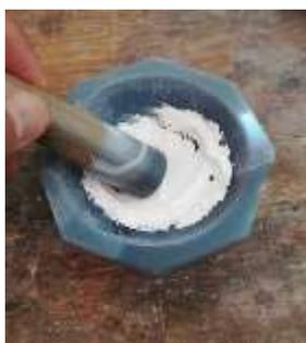
Figura 26. Pulverización de los cristales en un mortero ágata.
