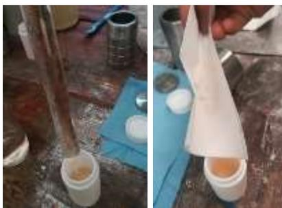
Figura 23a. Adición de 30 ml de solución NaOH.
