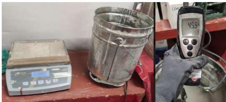
Figura 9. Lodos de arena sílica durante el proceso de calentamiento.
