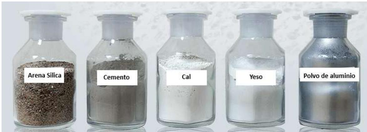
*Figura 4. Materias primas utilizadas para la síntesis del AAC.*
