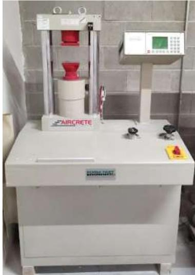
*Figura 15. Equipo para la determinación de fuerza de compresión marca TEST-FORM, propiedad de la empresa Aircrete México.*
