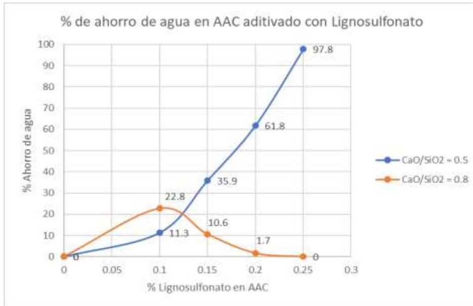
**Figura 46** Gráfico comparativo de reducción de agua en el AAC con lignosulfonato de sodio
