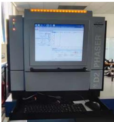
*Figura 7 Difractómetro BRUKER D2 PHASER propiedad de la UAEH, ICAP.*
