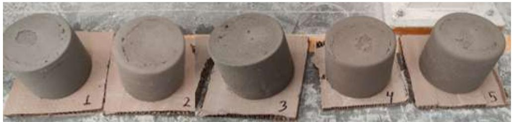
*Figura 13. Muestras de concreto celular autoclaveado previo al proceso de curado.*
