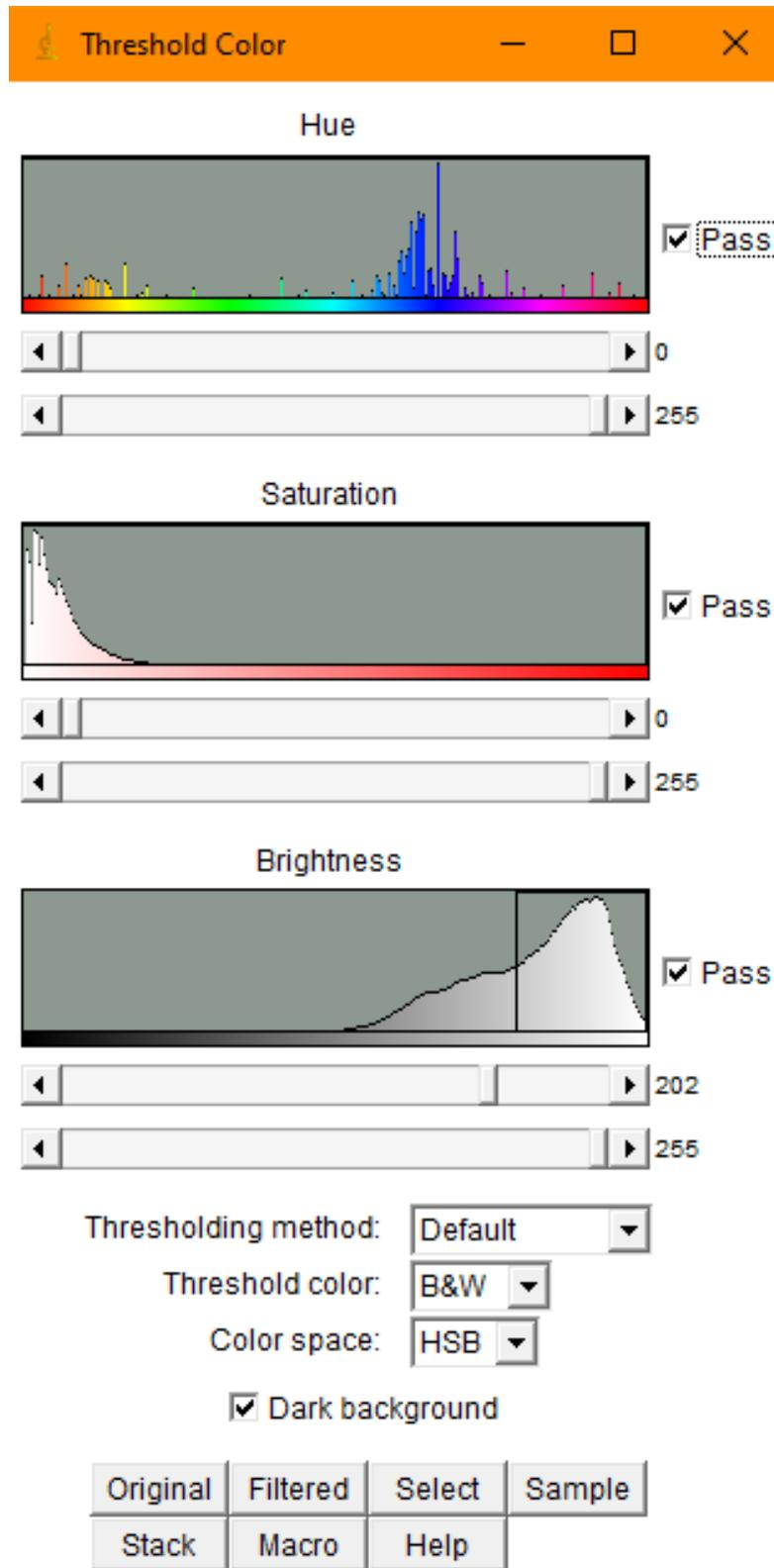
Figura IV.3 Ajustes y saturación para definición de las fases del acero *DP1000*
