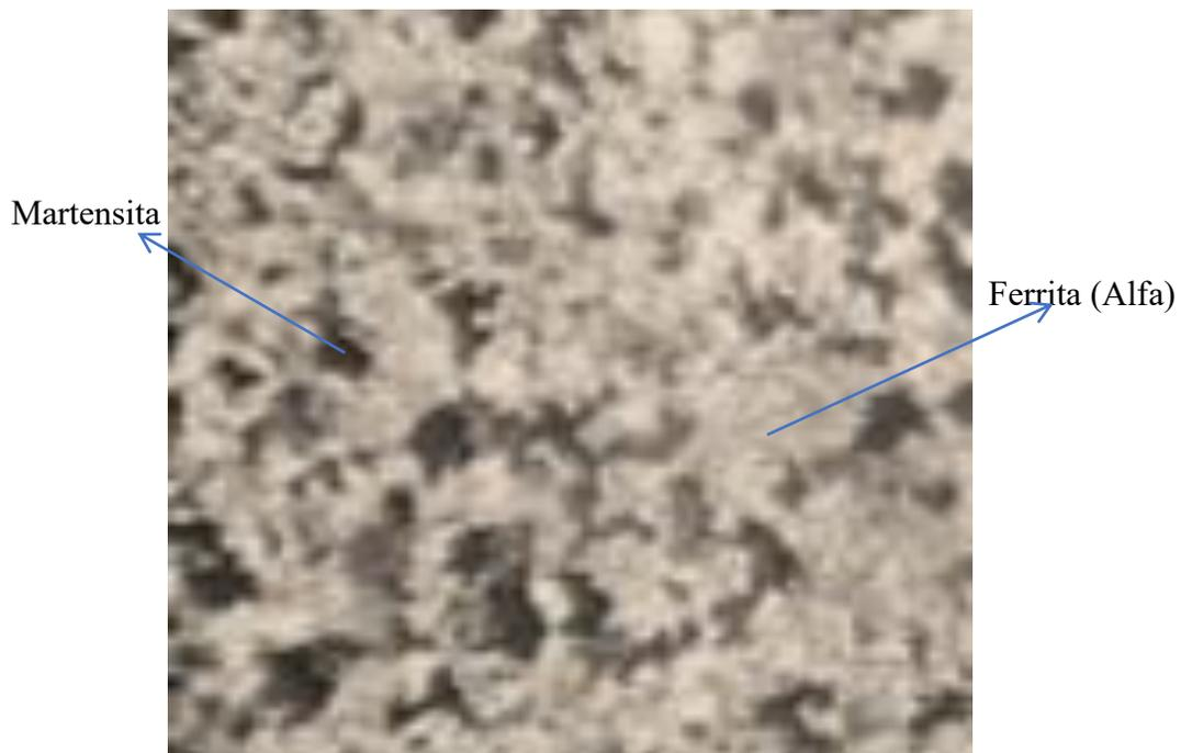
*Figura II.5. Esquema de las islas de martensita y la matriz de ferrita*
