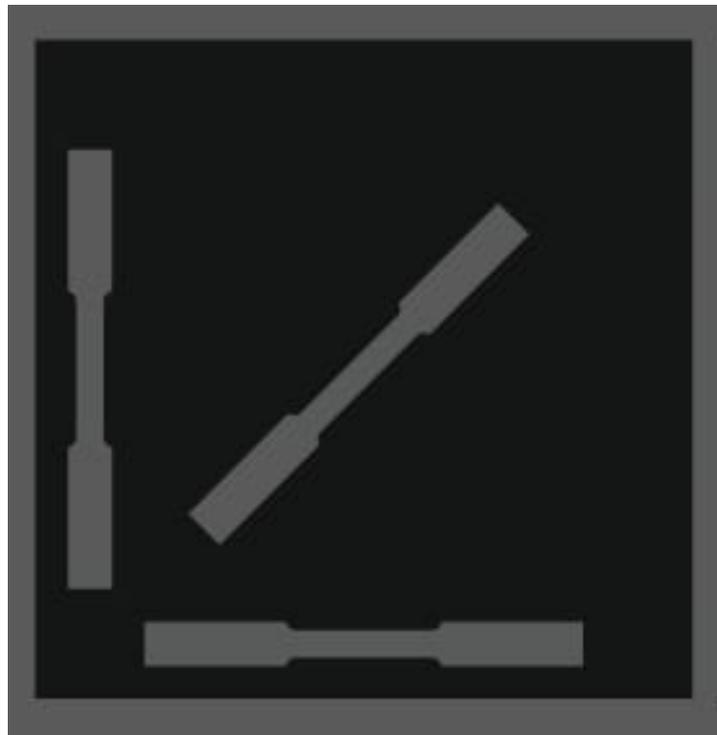
*Figura IV.10 Distribución de las probetas y la dirección de corte.*
