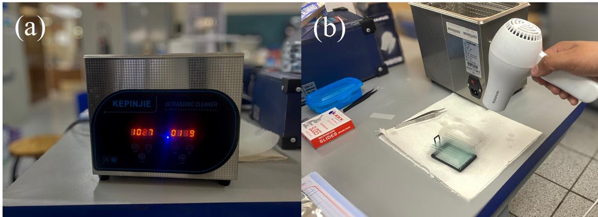
**Figura 4.1:** (a) Limpiador ultrasónico en funcionamiento; (b) secado de sustratos con una pistola de aire caliente.
