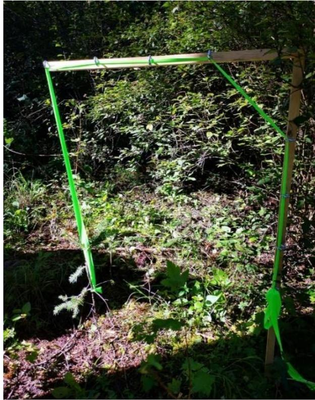
**Figura 9.** Soporte de madera para sujetar el árbol y extraer el sistema radicular completo del mismo.
