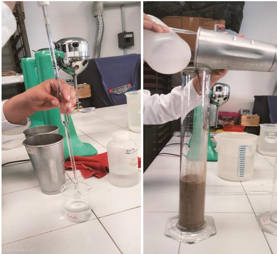
**Figura 18.** Agitación y llenado de probetas con muestras de suelo
