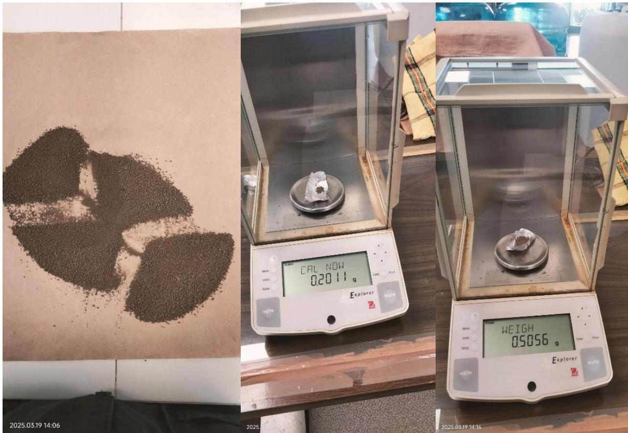
**Figura 21.** Cuarteo y pesado de muestras en laboratorio para determinar % de materia orgánica
