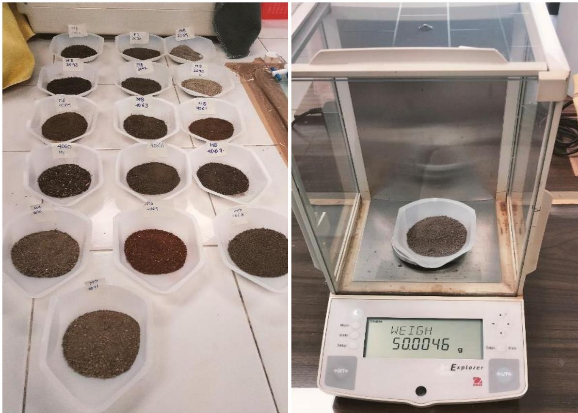
**Figura 17.** Clasificación y pesado de muestras de suelo para determinación de la textura
