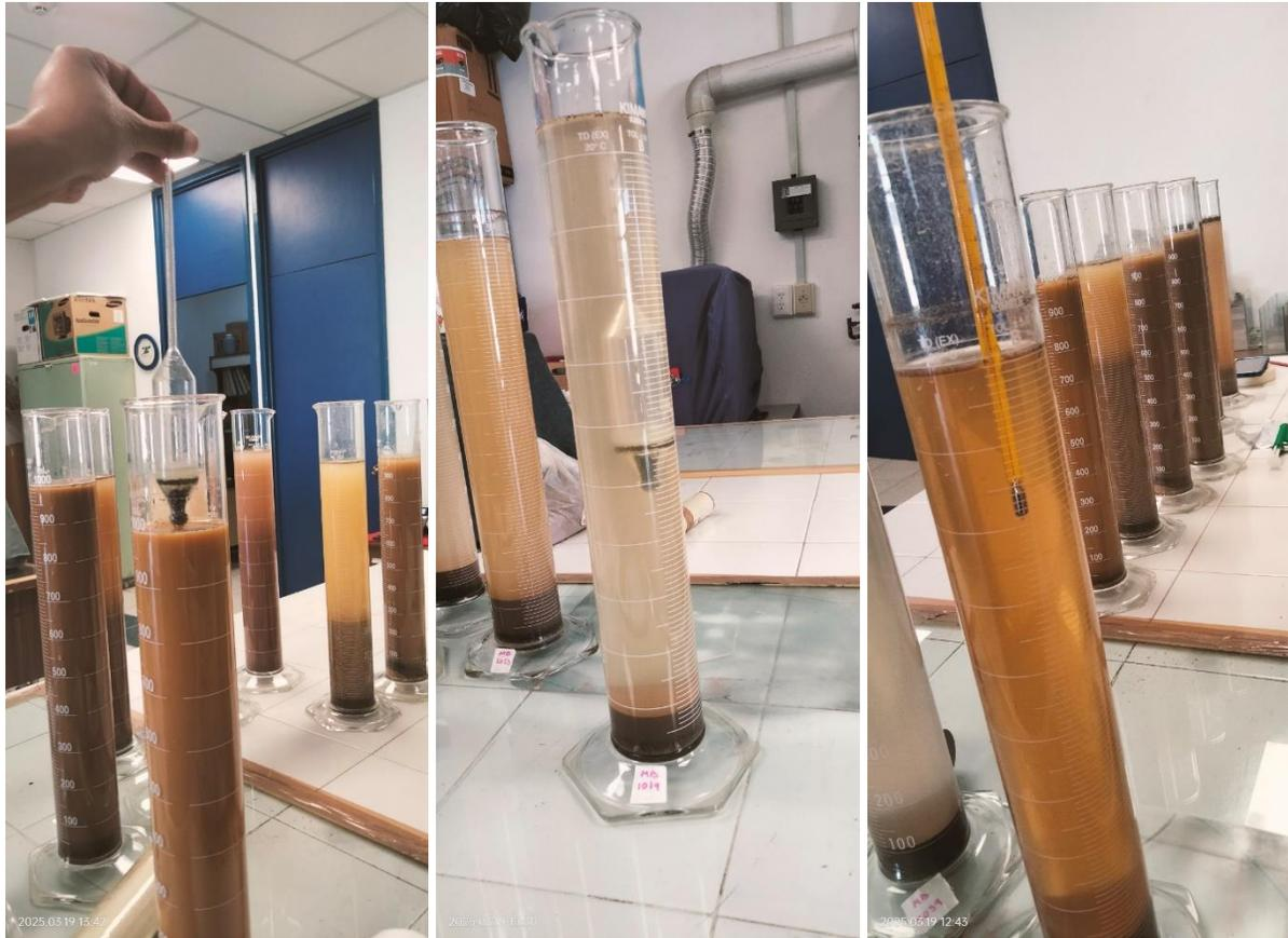
**Figura 19.** Medición de la densidad de la suspensión y temperatura a diferentes tiempos
