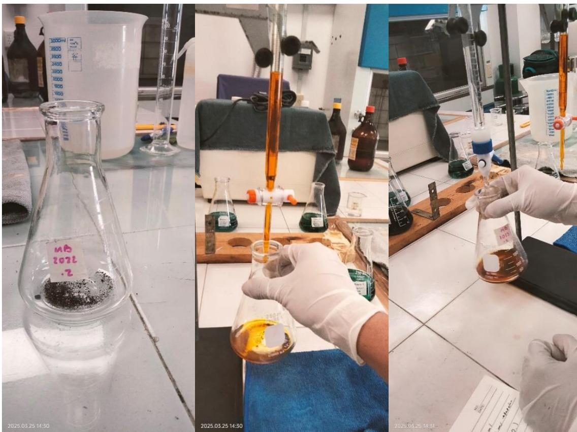
**Figura 22.** Oxidación de suelo en solución de dicromato de potasio y ácido sulfúrico
