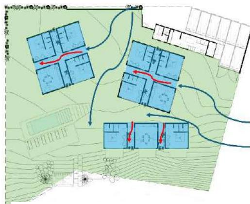
Figura 27. Esquema de ventilación
