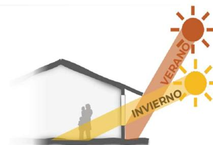
Figura 55. Esquema de incorporación incidencia solar. Fuente: Estrategias de diseño arquitectónico con enfoque bioclimático (SEDATU & CONAVI ,2022, p.12)
