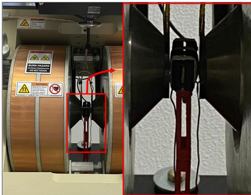
**Figura 3.18** Montaje para realizar las pruebas de magnetorresistencia.
