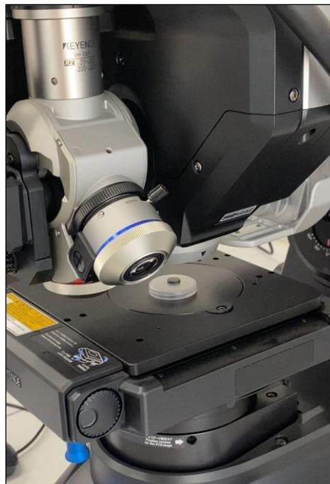
**Figura 3.20** Pastilla montada en el analizador elemental Keyence modelo EA-300.
