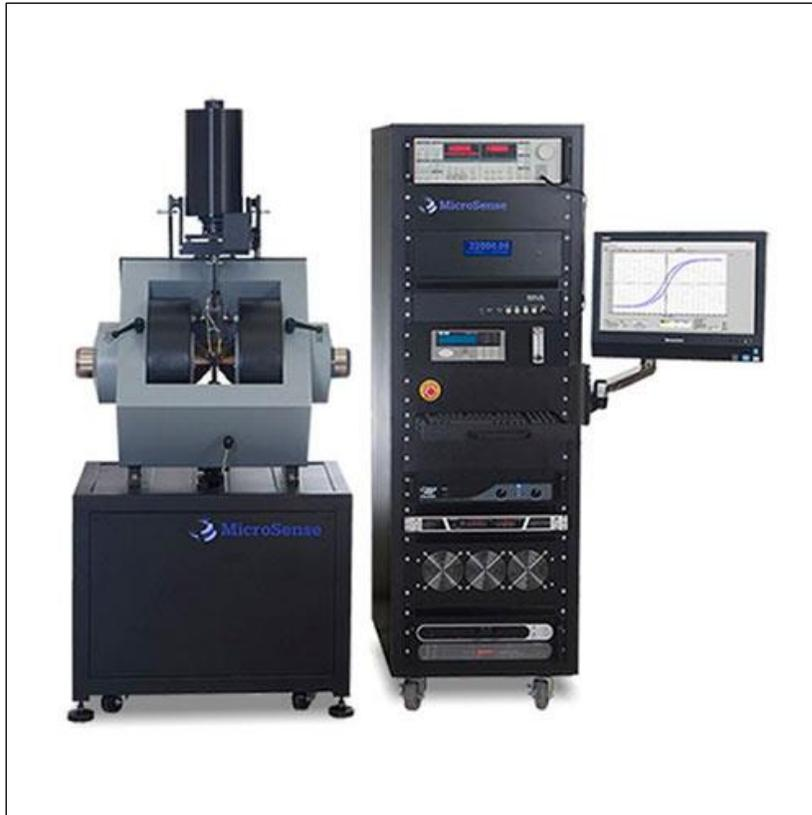
*Figura 3.8* Macrofoto del magnetómetro de muestra vibrante MicroSense® EV7.
