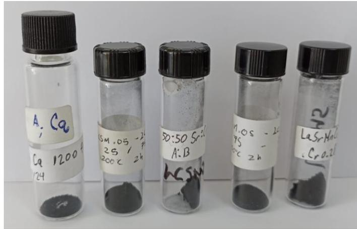
**Figura 4.5** Macrofoto de los polvos compósitos, modificando la relación en peso de los componentes LCaSM - LSMCr: (a) 0-100, (b) 75-25, (c) 50-50, (d) 25-75 y (e) 100-0.
