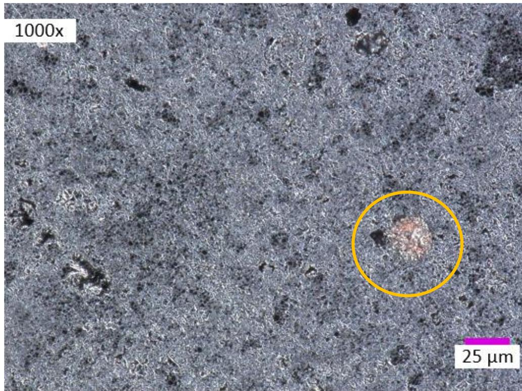
**Figura 4.32** Impurezas de  $\text{SiO}_2$  y Fe en los compactos compósitos de LCaSM:LSMCr con una proporción de 75:25, 50:50, respectivamente, sinterizados a  $1100^\circ\text{C}$  durante 4h.
