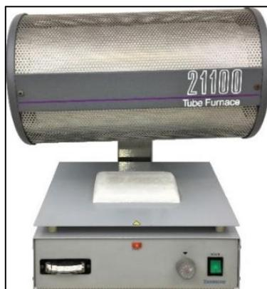
**Figura 3.5** Macrofoto de un horno tubular Barnstead Thermolyne® F21135.
