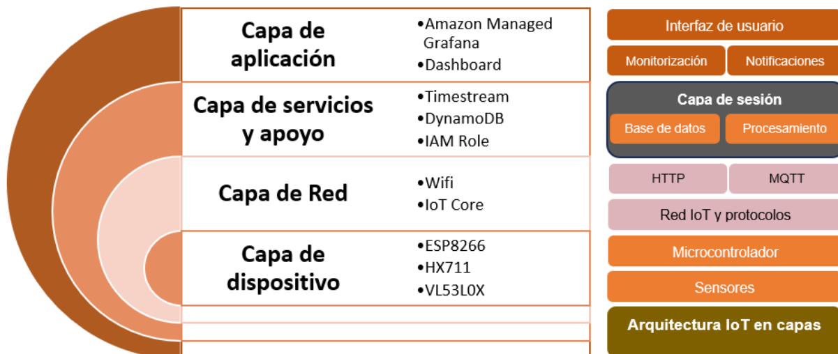
Figura 12. Diagrama de arquitectura en capas del prototipo. Fuente: Elaboración Propia.
