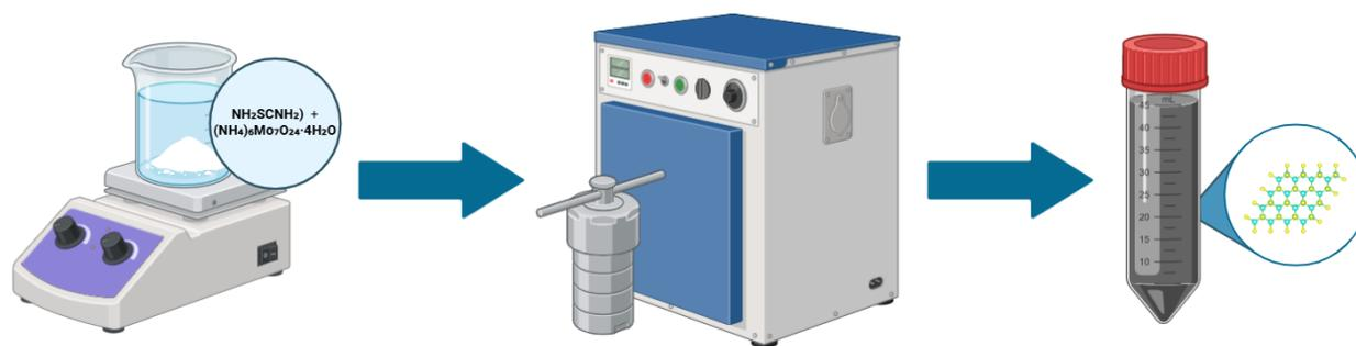
**Figura 8.** Esquema representativo de síntesis hidrotérmica para la obtención de nanohojas de  $\text{MoS}_2$ .
