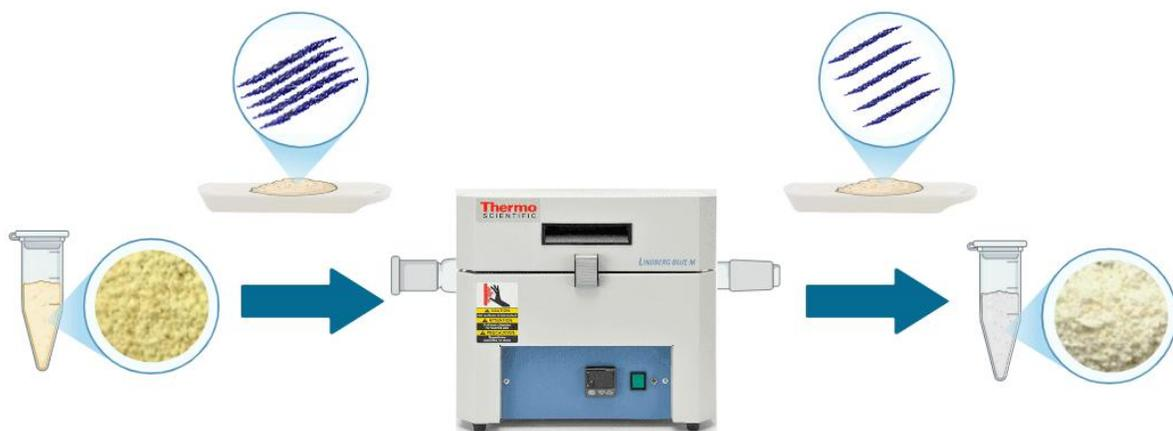
**Figura 6.** Esquema representativo del proceso de exfoliación térmica de  $g\text{-C}_3\text{N}_4$
