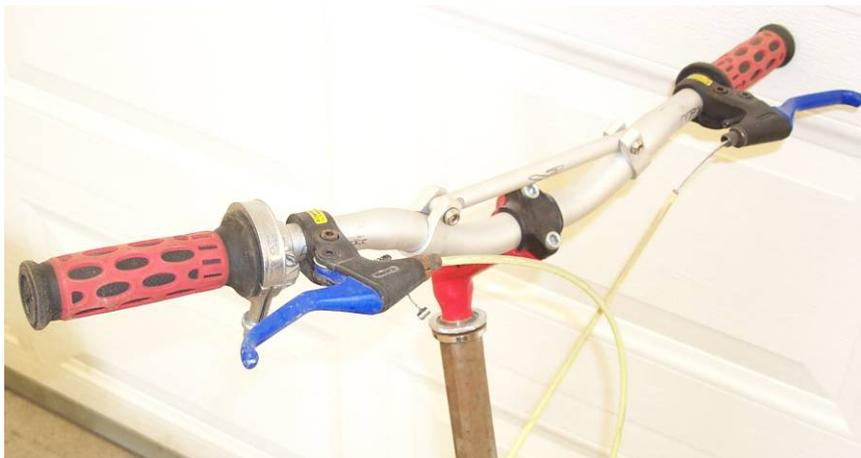
**Figura. 1.1** Detalle del manubrio tipo “Down Hill”
