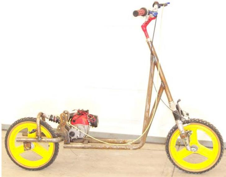
**Figura. 1.4** Prototipo doble suspensión rodada 16”.
