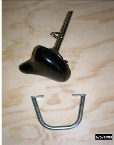
**Figura. A-3** Asiento y protección para motor.
