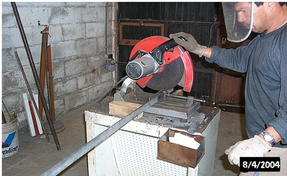
**Figura. 5.8.** Cortadora de disco 12”.
