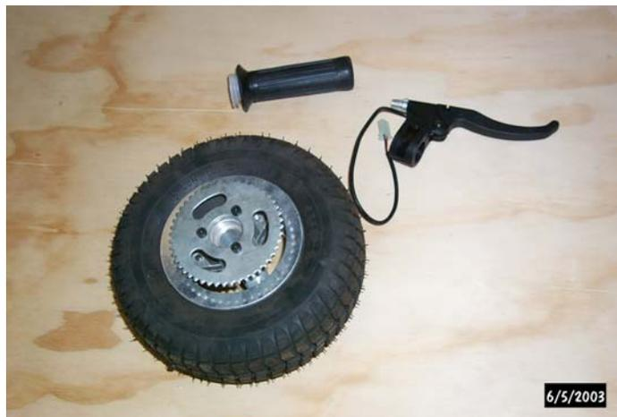
**Figura. A-2.** Llanta, puño y palanca de freno.
