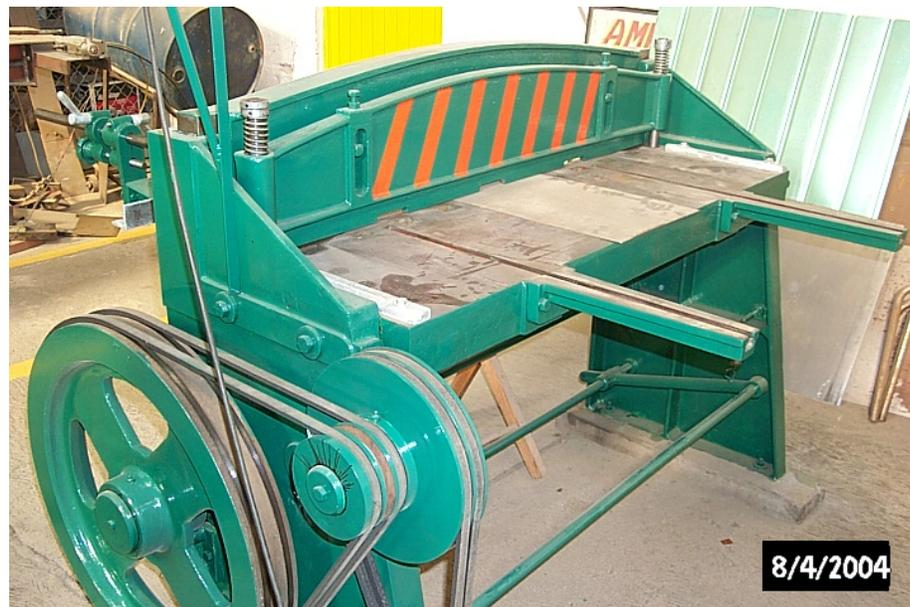
**Figura 5.7.** Cizalla para corte de lámina.
