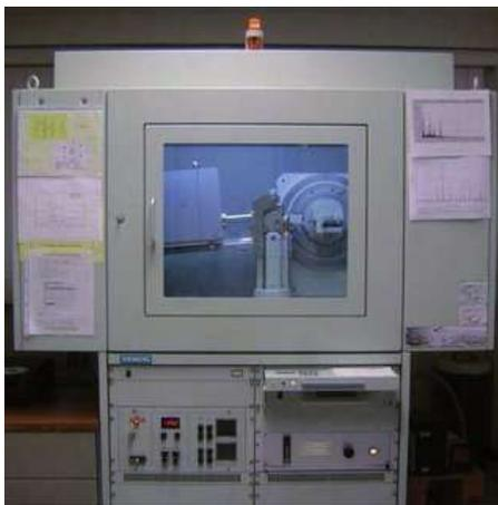
Figura 3.10. Difractómetro Siemens D5000.
