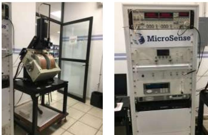
Figura 3.9. Magnetómetro marca MicroSense modelo EV7.
