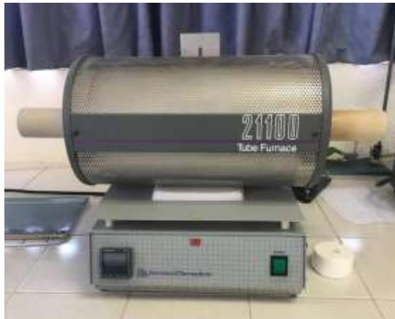
*Figura 3.7. Horno tubular Thermolyne F21100.*
