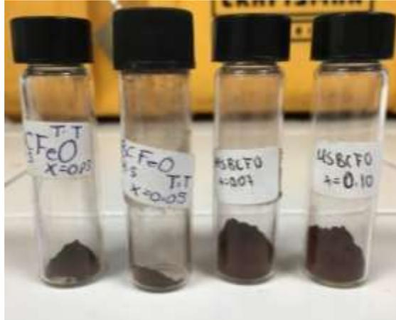
Figura 3.17. Polvos tratados térmicamente ya envasados para futura compactación y caracterización.
