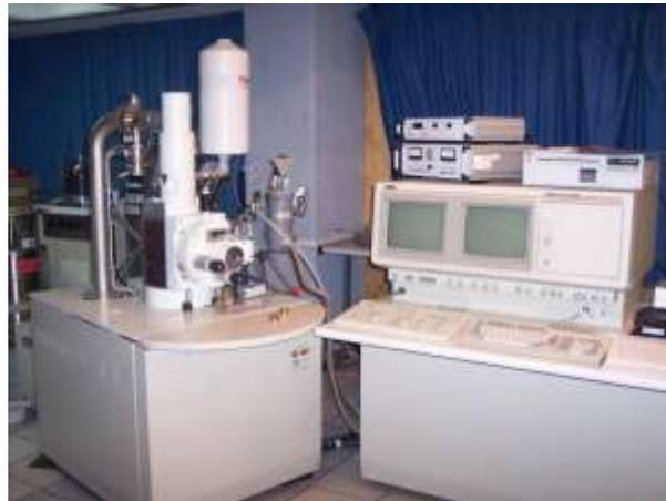
Figura 3.11. Microscopio electrónico de barrido JSM-6300.
