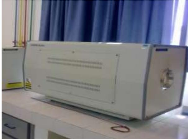
Figura 3.8. Horno tubular de tres zonas marca Lindberg/blue M.
