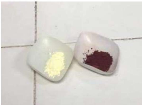
Figura 4.1. Polvos de  $\text{Bi}_2\text{O}_3$  y  $\text{Fe}_2\text{O}_3$
