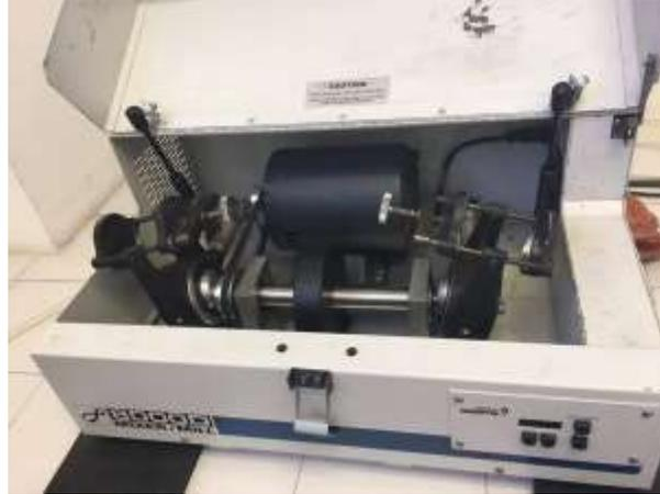
*Figura 3.6. Molino de alta energía de 5 ejes.*
