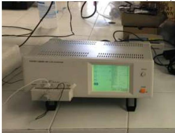
Figura 3.12. LCR Meter, marca HIOKI.
