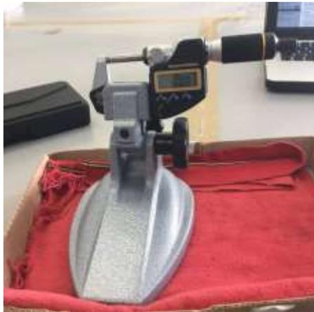
*Figura 3.20. Micrómetro digital.*
