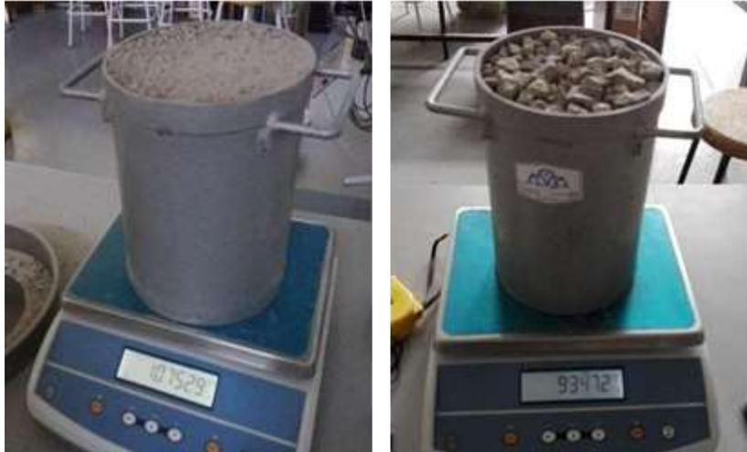
*Figura 7. Obtención del peso volumétrico.*
