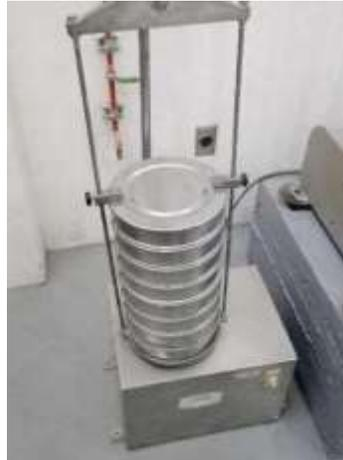
*Figura 10. Proceso de tamizado por medios mecánicos para la obtención del módulo de finura.*
