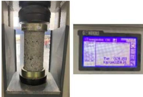
*Figura 11. Prueba de resistencia a la compresión.*
