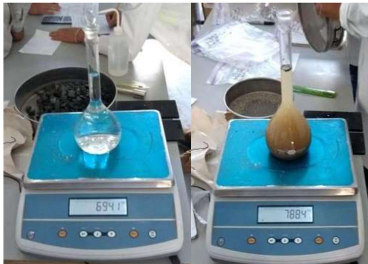
*Figura 8. Obtención del peso específico del agregado fino.*
