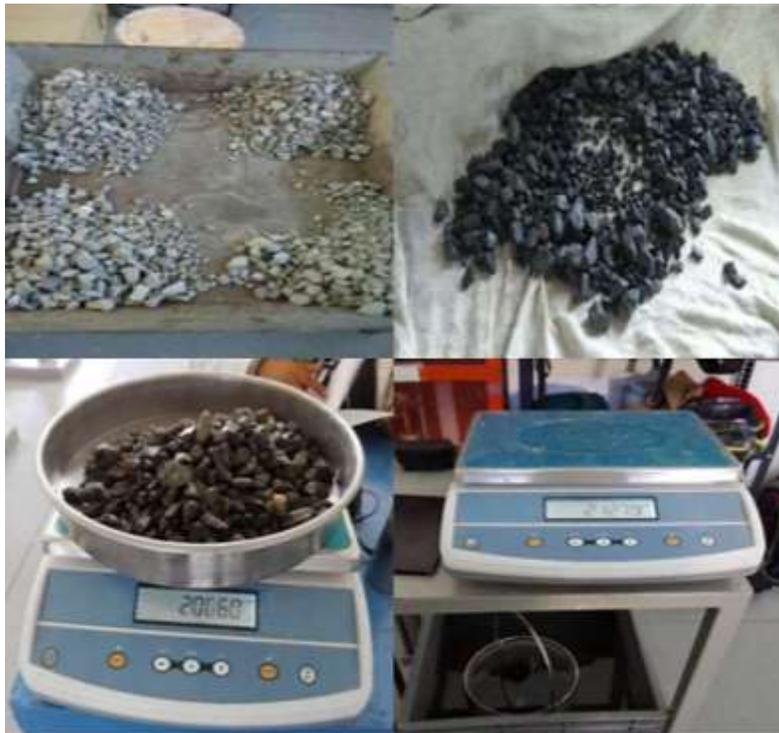
*Figura 9. Procedimiento para obtener el peso específico del agregado grueso.*
