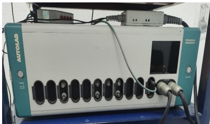
Ilustración 3. Potenciostato/galvanostato Autolab Model PGSTAT30
