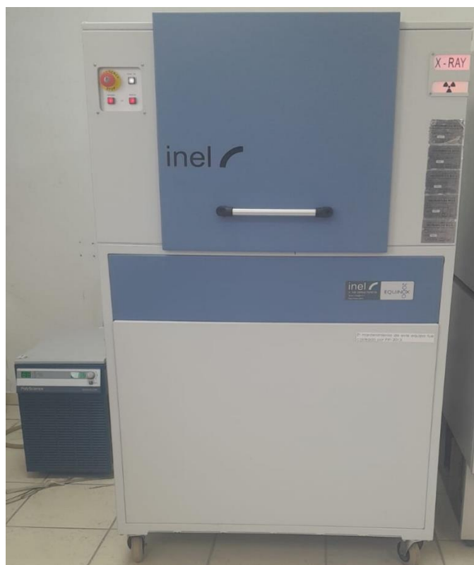
Ilustración 5. Difractómetro de rayos X. Equinox 2000, de la marca Inel.
