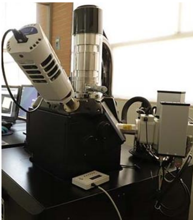
Ilustración 6. Microscopio electrónico de barrido. MEB JEOL modelo IT300.
