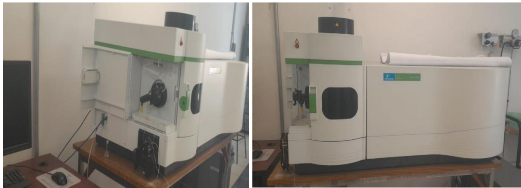
Ilustración 4. Espectrómetro PerkinElmer. Modelo optima 3800 con detector en posición axial.
