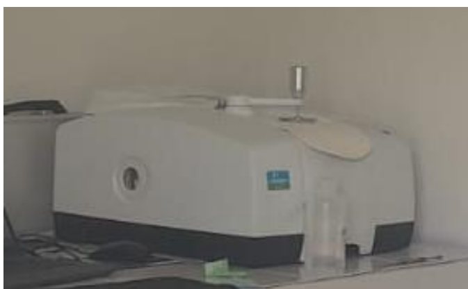
Ilustración 7. Espectrofotómetro FT-IR Frontier. Marca Perkin Elmer, System 2000.
