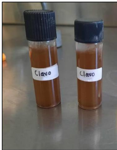
**Figura 6:** Aceite esencial de *S. aromaticum*, resultante del proceso de destilación por arrastre de vapor.
