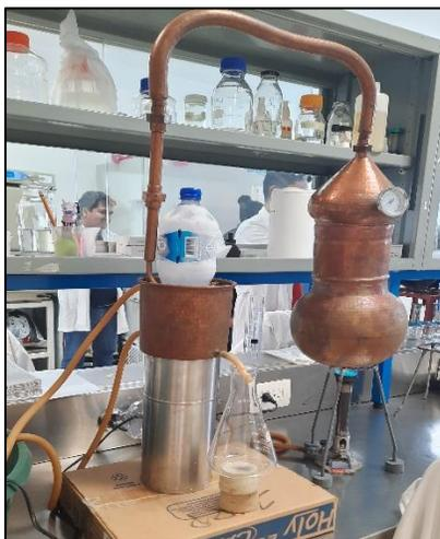
**Figura 1:** Alambique de cobre empleado para la extracción del aceite esencial de *S. aromaticum*, mediante la técnica de arrastre de vapor.
