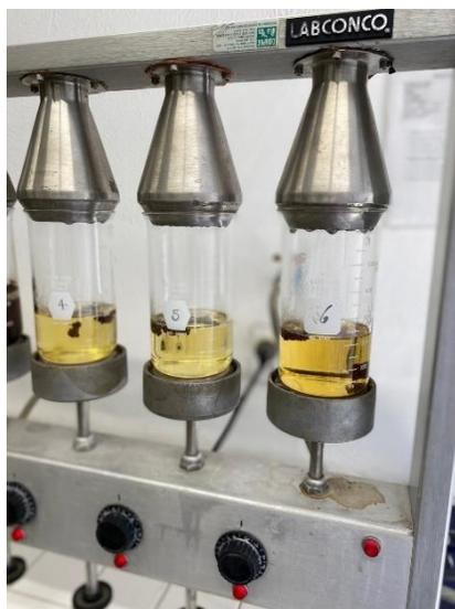
Figura 3. Equipo utilizado para la determinación de fibra cruda
