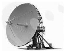
Fig. 2.7 Antena Cassegrain (imagen tomada de la red) (7)
