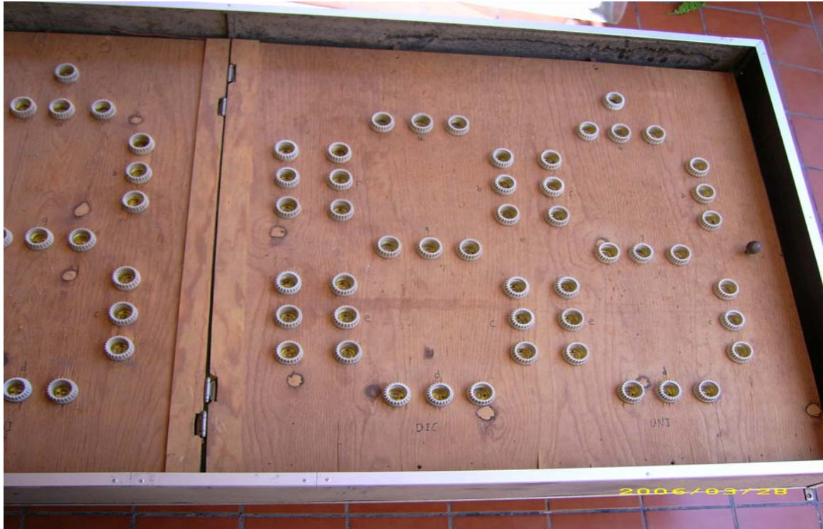
Figura 2.6: Colocación de los Displays 7-segmentos.
