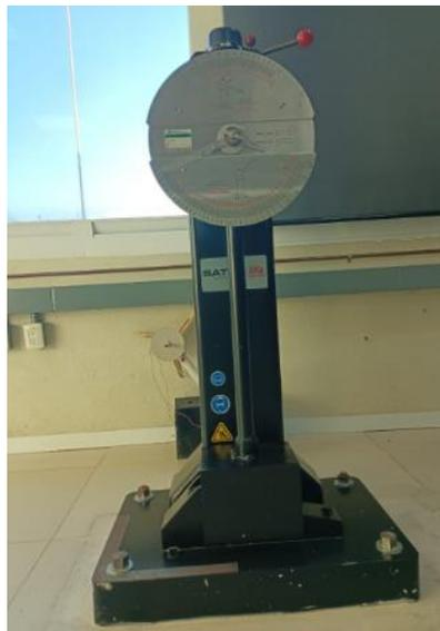
Figura 37. Máquina para ensayos de impacto Charpy
