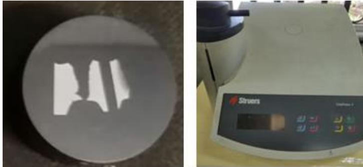
Figura 33. a) Pieza montada en baquelita, b) Montadora de probetas en baquelita
