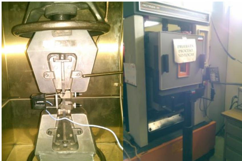
Figura 36. Máquina de ensayos de tensión
