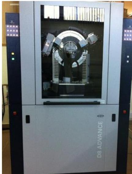
Figura 35. Equipo de difracción de rayos x marca Bruker.
