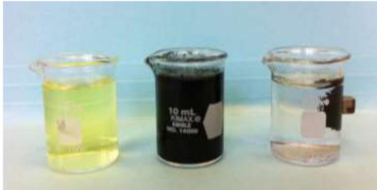
**Figura 3.** Experimento de adsorción. De izquierda a derecha: Disolución de tartrazina, Mezcla de tartrazina con el soporte magnético, Separación del soporte magnético.
