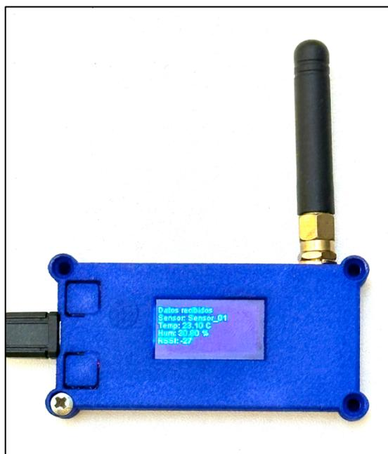
FIGURA 18 PROTOTIPO FUNCIONAL GATEWAY
