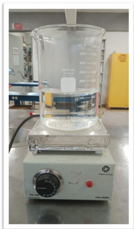
Figura 7. Parrilla de calentamiento.
