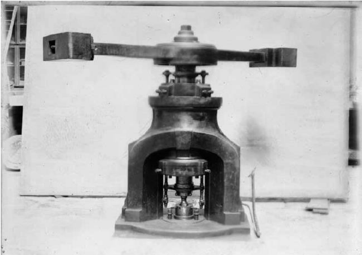
Figura 3.13 Prensa de volante. La prensa mostrada perteneció a la Casa de Moneda y es ejemplo de las que comenzaron a usarse en la Nueva España a principios del siglo XVIII, desplazando la ancestral tecnología basada en el golpe de martillo. El modelo que aparece en la foto fue desechado años después de tomarse esta imagen.
