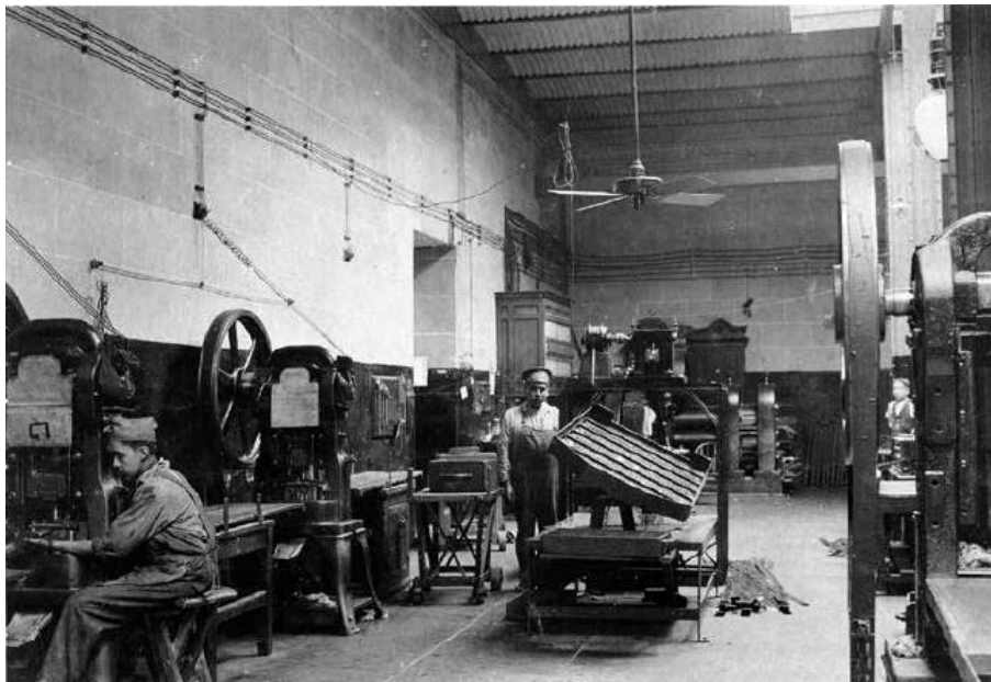
Figura 3.11 Corte de cospeles. Un operario en primer plano hace pasar láminas que ya han pasado las tres etapas de laminación a través de una prensa de corte, lo que da origen a los cospeles. Al centro de la toma, otro operario junto a una “zaranda” de fabricación local: se trata de una criba mecanizada con la que eran eliminados los cospeles “mochos”, producto de un corte defectuoso.
