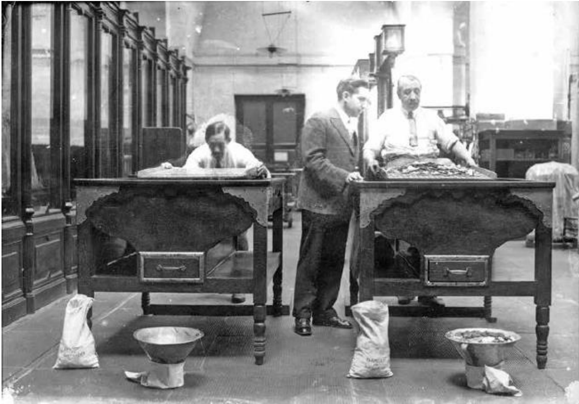
Figura 3.17 Contadora manual. Una vez acuñada, la moneda debe ser contada. En la planta de Apartado a finales del siglo XIX comenzaron a usarse contadores manuales o de mesa como la que muestra la foto. La parte principal del conjunto es la tabla ranurada, en la que mediante vigorosas sacudidas las monedas se alinean perfectamente; una vez logrado, el conteo es aritméticamente infalible: tantas piezas por ranura, por el número de ranuras en la tabla. En plena era digital, las monedas de oro siguen siendo entregadas a los cajeros del Banco de México mediante una contadora de este tipo.
