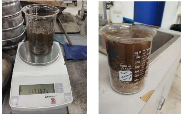
**Figura 3.6. Prueba de absorción de agua.**
