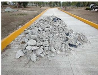
Figura 3.1 Banco de RCD utilizado.
