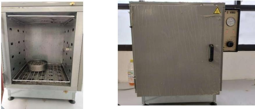
Figura 3.5. Secado de agregados.
