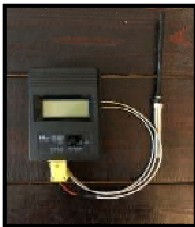
Figura 17. Termopar utilizado para medir las temperaturas alcanzadas dentro del gasificador.
