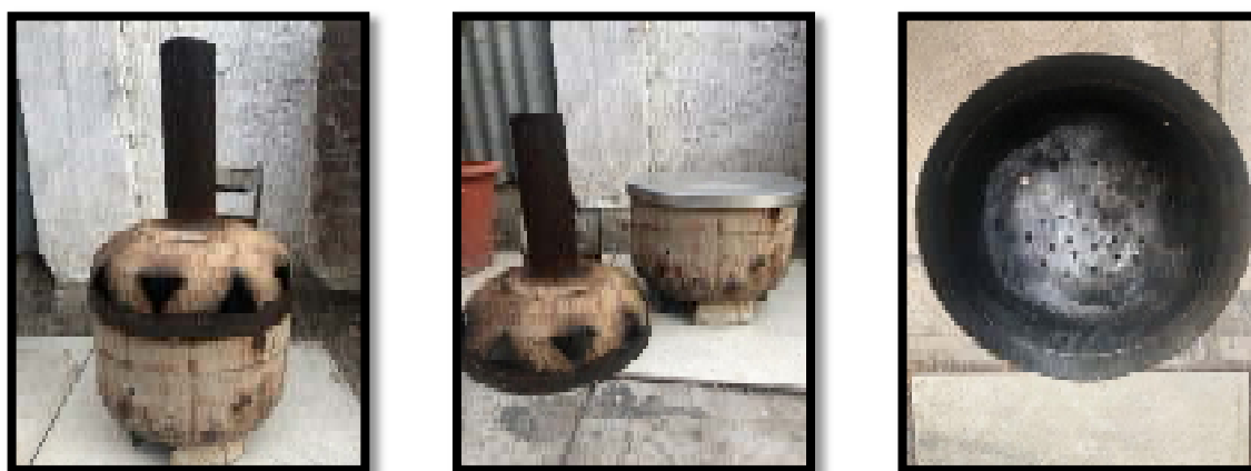
Figura 14. Imágenes del gasificador TLUD completo (izquierda), corona y chimenea junto a la cámara de combustión con la tapa (centro) y cámara de combustión con los orificios inferiores (derecha).
