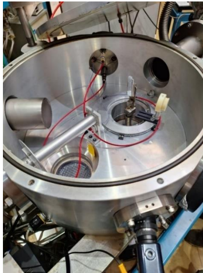
Figura 3.6. Fotografía de la cámara de RBS abierta, tomada en el laboratorio del Pelletron del Instituto de Física de la Universidad Nacional Autónoma de México (IFUNAM).
