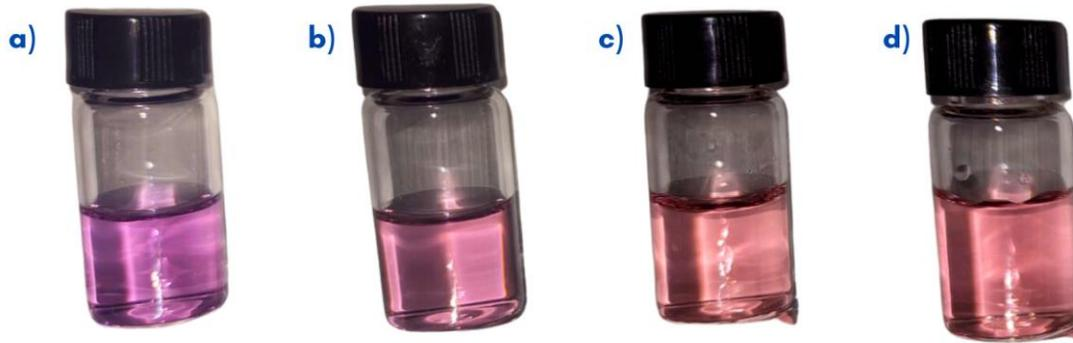
**Figura 13. AuNPs producidas por ALPL en a) etanol, b) isopropanol, c) agua destilada y d) agua desionizada.**
