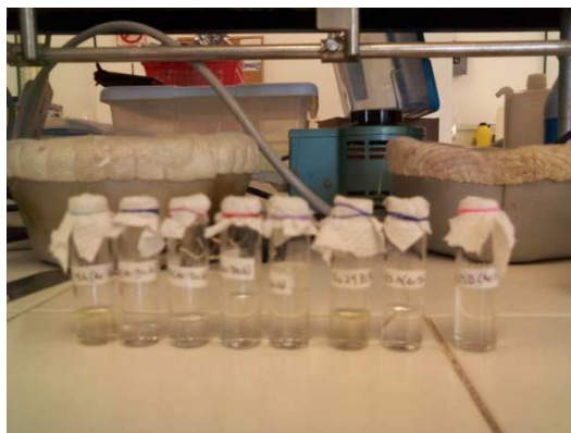
Foto 5.6. Viales de vidrio (previamente pesados) con tapa de papel absorbente
