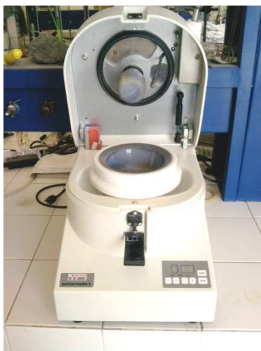
Foto 5.2. Pulverizador modelo Pulverisette 2 marca Fritch constituido por un mortero y un pistilo de ágata
