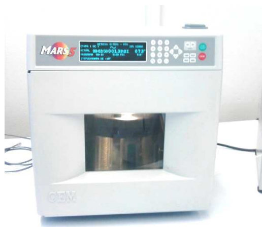
Foto 5.3. Equipo de Microondas modelo MARS 5, marca CEM, versión 049031
