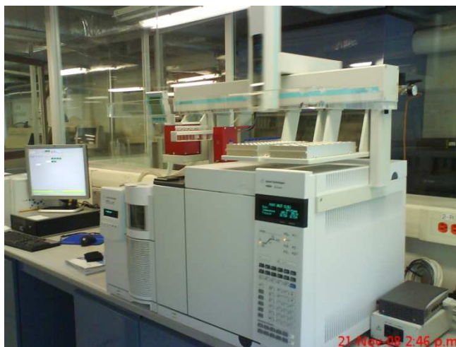
Foto 5.8. Cromatógrafo de Gases marca Hewlett Packard (HP) modelo 6890N con sistema de inyección splitless acoplado a un Espectrómetro de Masa marca HP modelo 5973N
