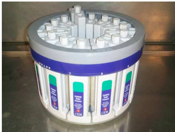
Foto 5.4 Tornamesa de Microondas con 14 vasos de teflón
