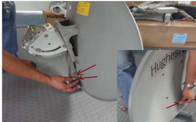
Figura 2.16: Montaje del brazo sobre el plato
