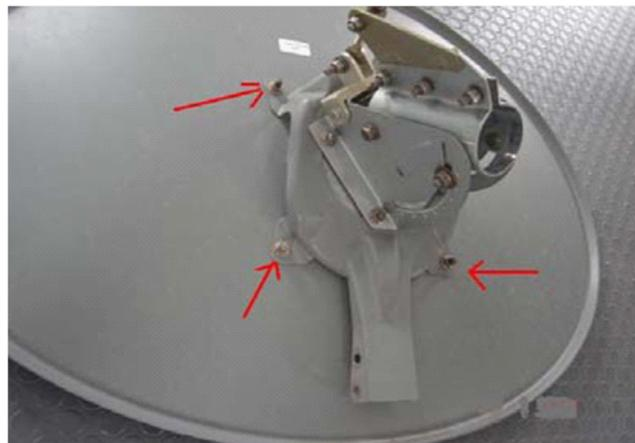
Figura 2.14: Montaje del contenedor en reflector
