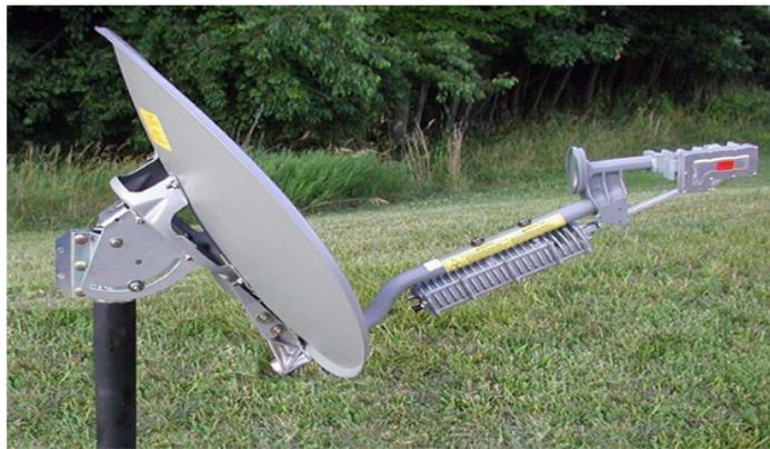
Figura 2.18: Montaje del plato sobre la base
