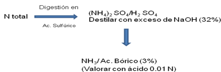
Figura 8. Reacción para la determinación de nitrógeno total por el método de Kjeldahl (Pearson, 1976).
