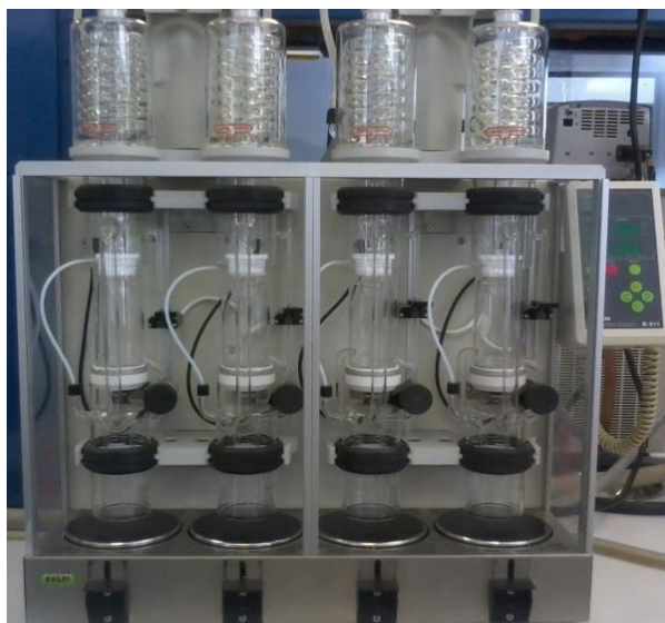
Figura 10. Sistema universal de extracción de grasas BÜCHI B – 811 (Büchi Labortechnik AG, Flawil, Suiza).
