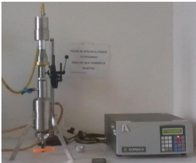
Figura 9. Procesador de ultrasonidos VCX – 1500, Sonic & Materials, Inc. Newtown, CT, Estados Unidos.
