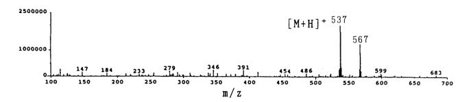
Fig. 10: Espectro inicial de masas de licopeno obtenido con un equipo HP GC-TANDEM(TOF)MS que es un sistema de cromatografía de gases con colector de cuádruplo combinado con un detector de tiempo de vuelo.
