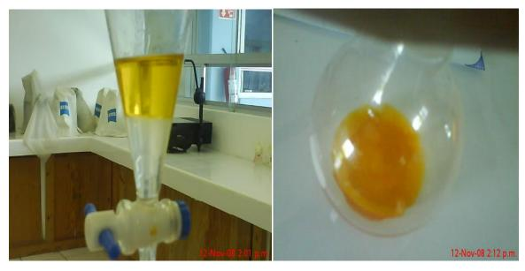
Fig. 4: separación de fases de extracción de la oleorresina jugo de jitomate.
