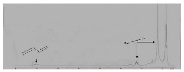
Fig. 13: Espectro de RMN de H (protón) utilizando CDCl3 (cloroformo deuterado) como disolvente. Se observa a campo alto las señales de metilos y a campo bajo a 5ppm los grupos conjugados C-H que contiene el licopeno.
