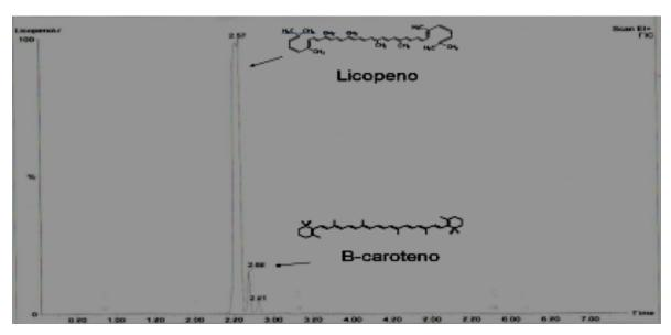
Fig. 12: Gráfica experimental que muestra la presencia de licopeno por la técnica de Cromatografía de gases. El tiempo de retención para el licopeno es de 2.57 min. B-caroteno es 2.68 y el compuesto minoritario, posible descomposición del licopeno aparece a los 2.81.
