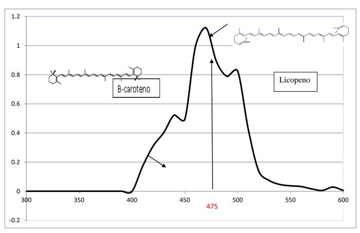
Fig. 8: Se indica que la máxima absorción del licopeno contenido en la oleorresina fue a 475 nm
