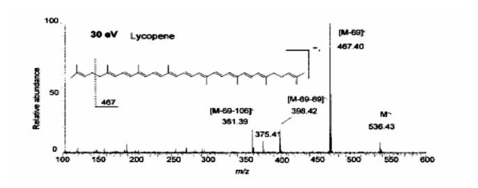
Fig. 11: Espectro de tándem iónico del lon radical *m/z* 536.43 del licopeno con el modo NICI (ionización química del lon negativo). La disociación inducida por colisión fue realizada con gas Argón a 30 eV.
