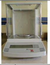
BALANZA ANALÍTICA Modelo EP213C, Explorer Pro.
