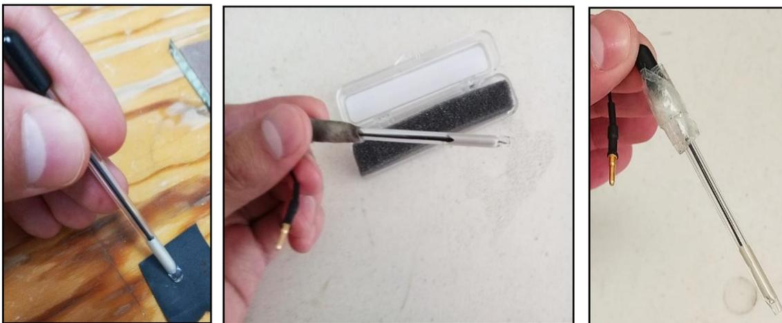
**Figura 3.7** UME de FC modelo MF-2007 con un Do. de 11  $\mu\text{m}$  Comercial marca BASI®
