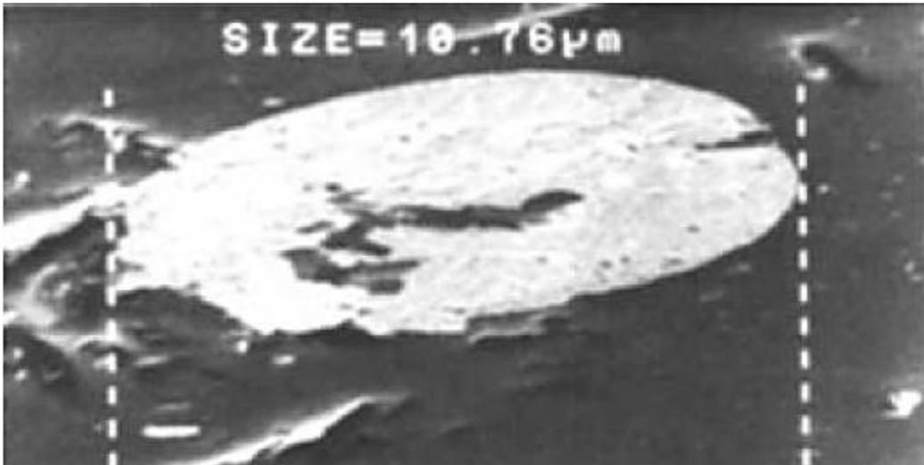
**Figura 2.7** Micrografía electrónica de un electrodo de Disco de Platino con un Do. de 10  $\mu\text{m}$  incrustado en vidrio [29].
