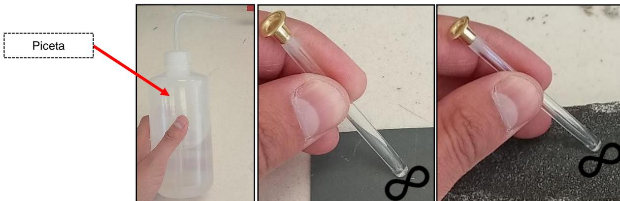
**Figura 3.12** Formación del acabado espejo en el UME artesanal.
