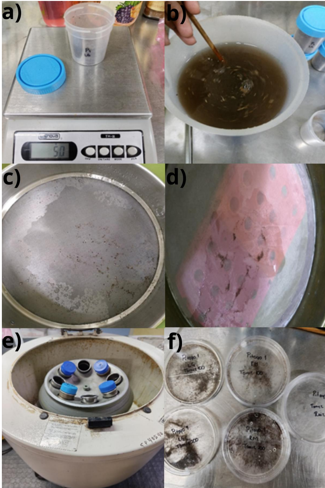
Figura 5. Procesamiento de las muestras. a) Peso de la muestra; b) Agitación de la muestra; c) Colecta del tamiz de 100 \mu m; d) Colecta del tamiz de 200 \mu m; e) Centrifugado de las muestras; f) Transferencia de contenido a caja Petri.
