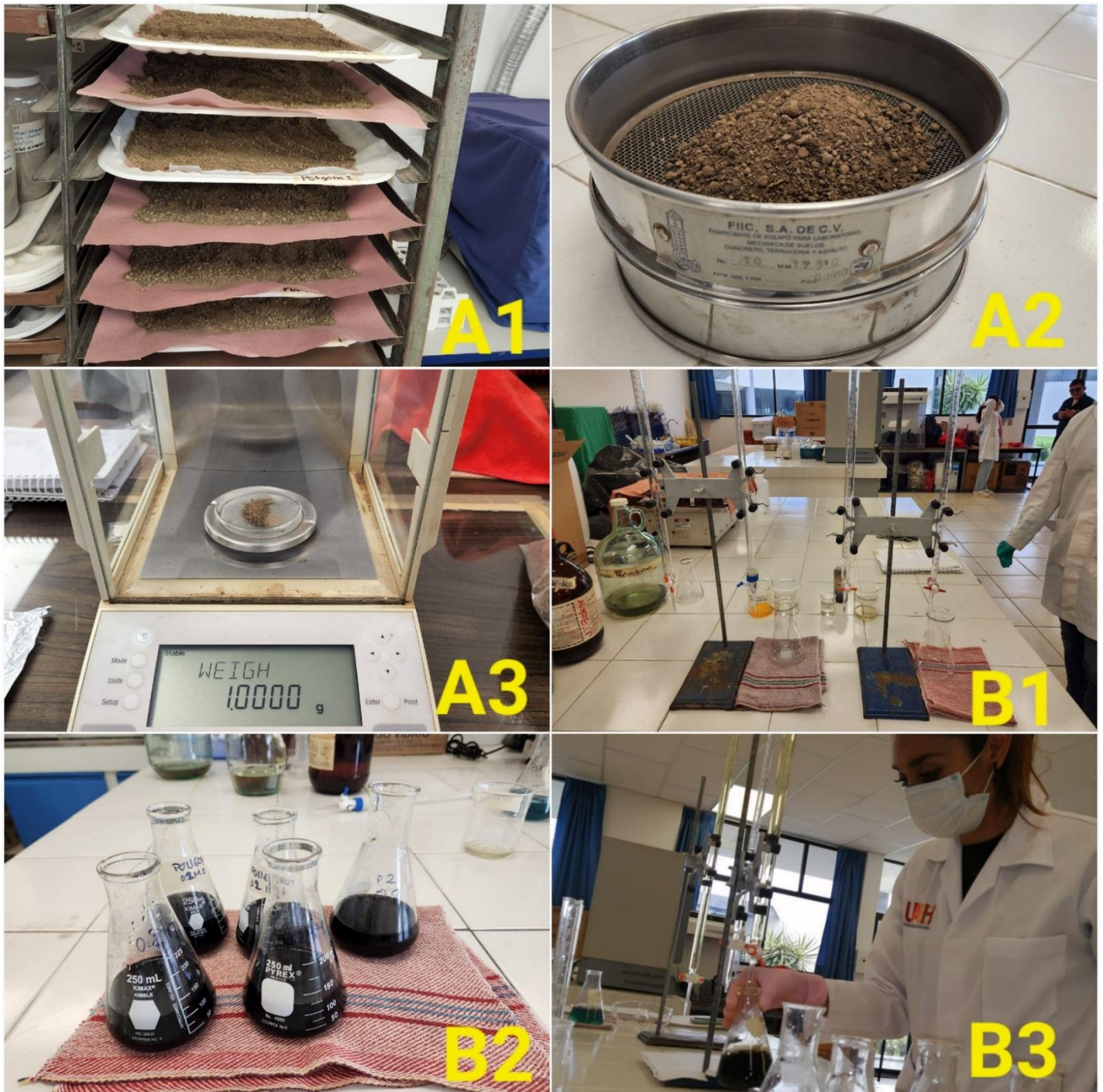
Figura 1.- Análisis en laboratorio de los parámetros físico-químicos de las muestras de suelo. Las imágenes A1, A2, A3 secado, tamizado y peso de cada muestra, imágenes B1, B2, B3 técnica de determinación de materia orgánica por el método de Método de Walkley and Black conforme a lo establecido en la NOM 021 RECNAT 2000.
