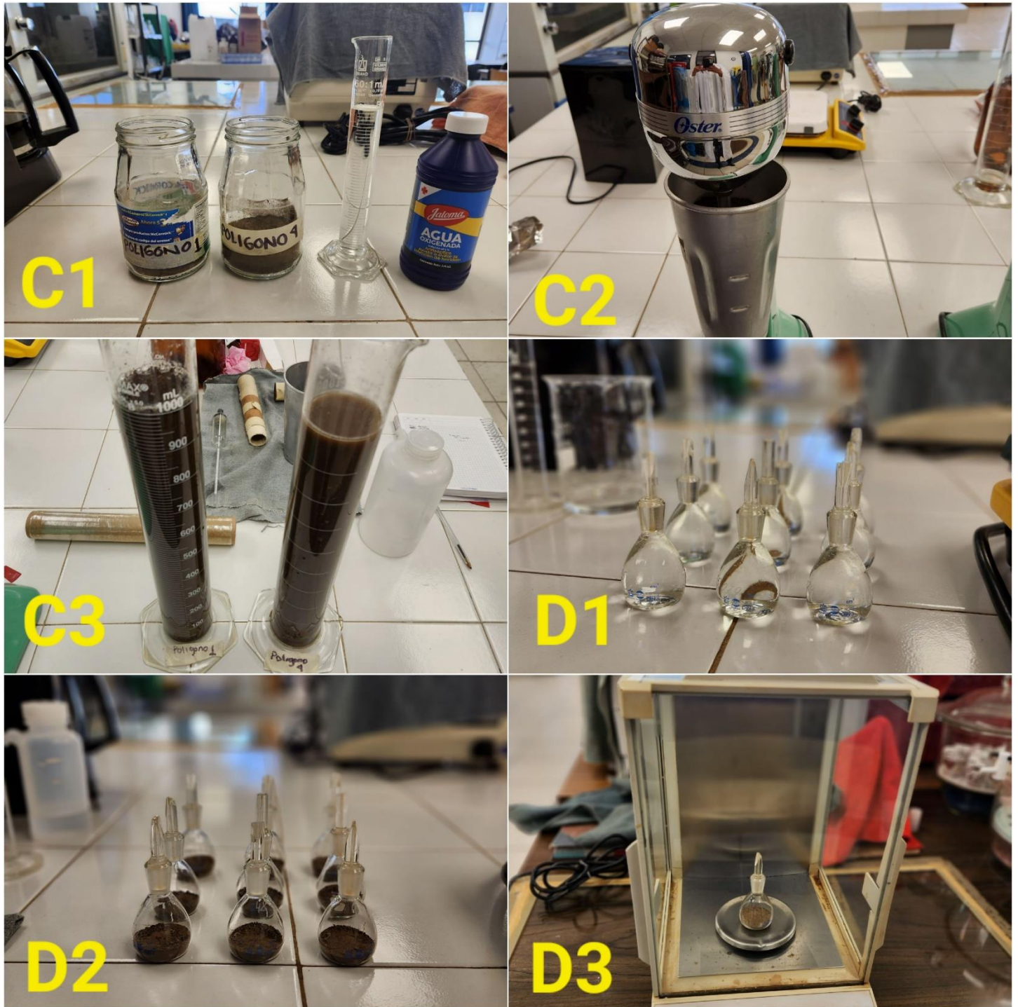
Figura 2.- Análisis de los parámetros físico-químicos de las muestras de suelo. Las imágenes C1, C2, C3 muestran la determinación de la clase textural mediante el procedimiento de Bouyoucos, las imágenes D1, D2, D3 muestran la determinación de la densidad real Mediante el método del picnómetro conforme a lo establecido en la NOM 021 RECNAT 2000.
