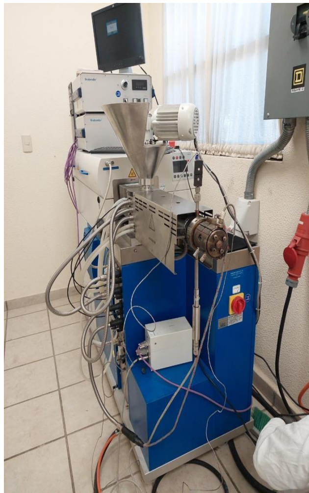
Figura 2. Extrusor de laboratorio Brabender, modelo 832005.007.
