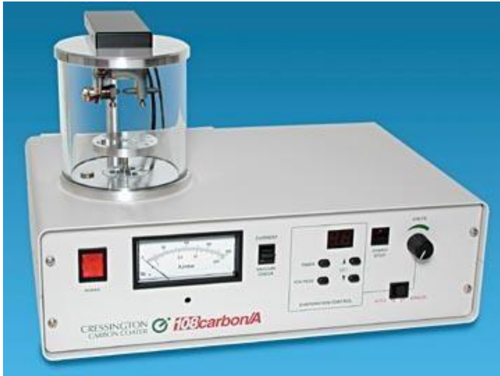
Figura 5. Evaporadora para recubrir con oro o grafito muestras para MEB-EDS.
