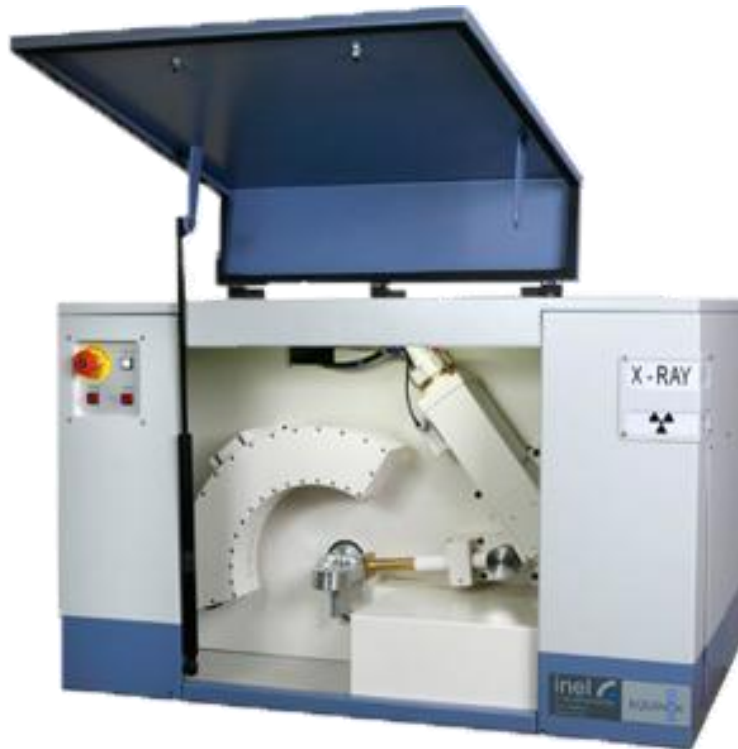
Figura 3. Equipo de Difracción de Rayos - X, INEL EQUINOX 2000, ubicado en la UAEH-AACTyM.
