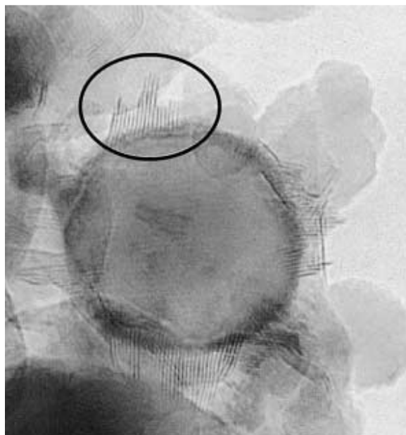
Figura I.6. Micrografía de cúmulos de MoS 2 “edge bonded” soportados en TiO 2 [80] .
