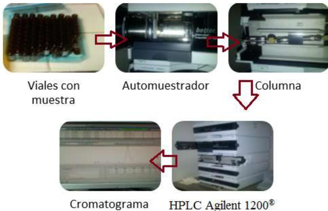
Figura III.10. Cuantificación de atrazina por HPLC. Agilent 1200®, serie infinity.
