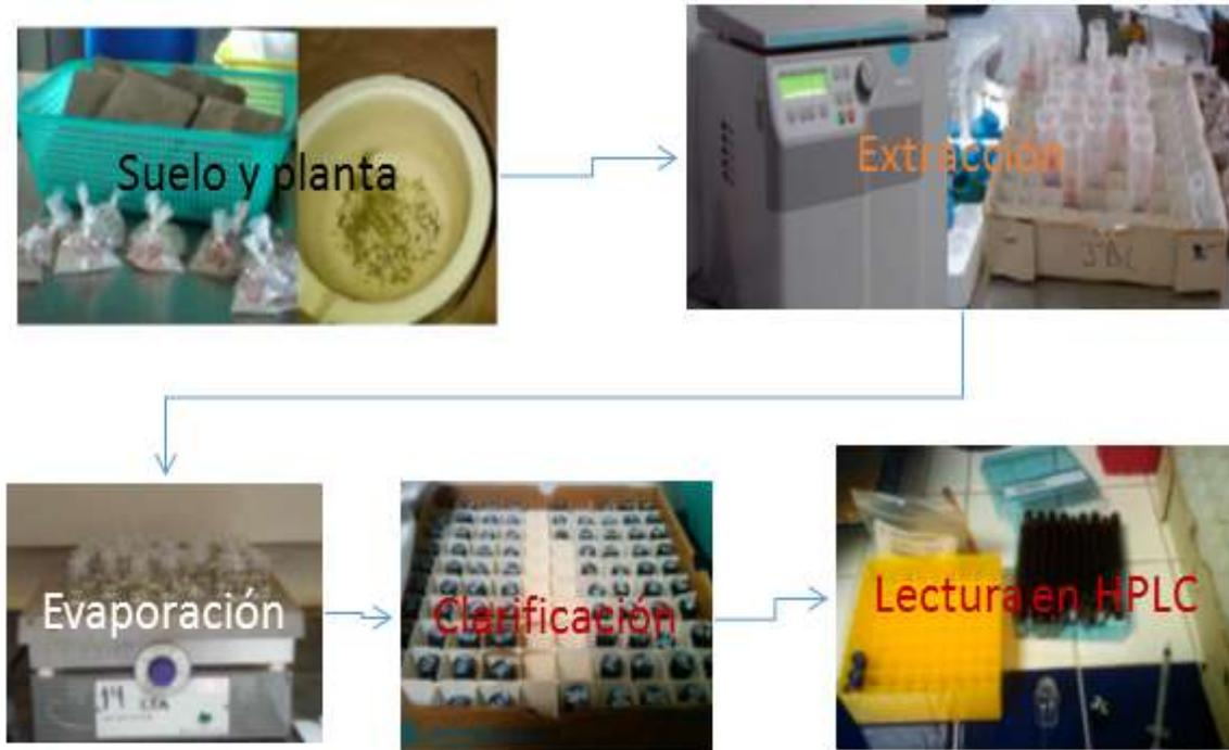
Figura III.9. Extracción de atrazina en muestras de suelo y planta.
