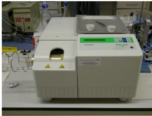
Figura 3.13 Analizador termogravimétrico (TGA) para analizar cambios del material en función de la temperatura.
