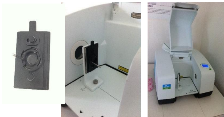
Figura 3.7 Colocación de la pastilla en el espectro infrarrojo.
