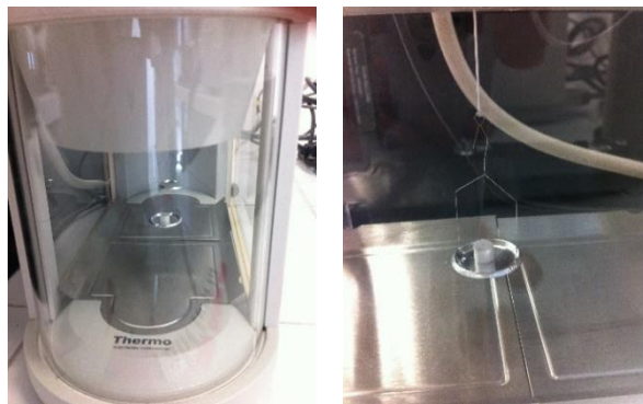
Figura 3.8 Preparación de las muestra para análisis termogravimétrico.
